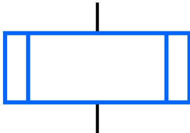
Блок «предопределённый процесс»
