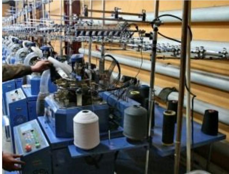
Второй этап характеризуется применением полуавтоматизированных кеттельных машин, на вход которых операторы закладывают заготовку. Все дальнейшие процессы не требуют вмешательства человека и выполняются автоматически. Иногда для того чтобы зашить мысок на заготовке, используют и ручную кеттельную машину. После того как носок зашит, он снова поступает в корзину-накопитель.
