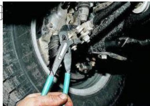
Проверка и регулировка схождения и развала колес
