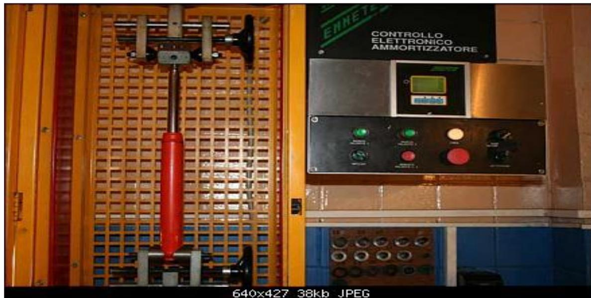
**Стенд проверки амортизаторов.**
