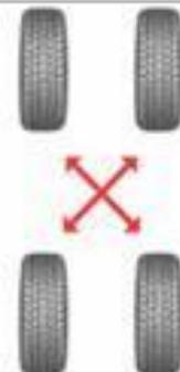
**Предпочтительная схема перестановки в случае направленного протектора**
