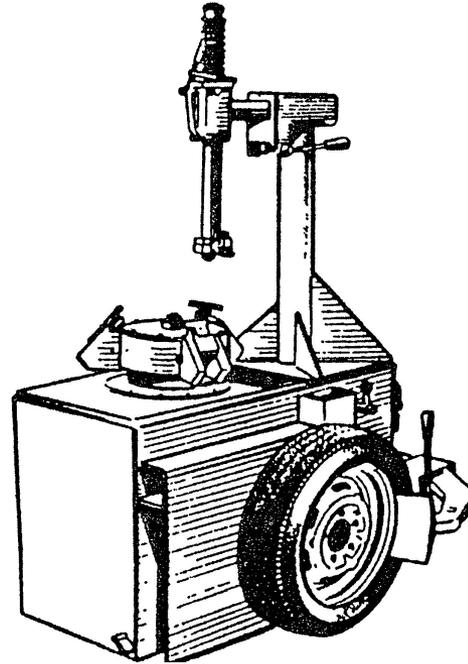
**Стенд для монтажа шин**
