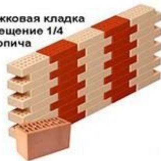
ложковая кладка косое смещение 1/4 кирпича
