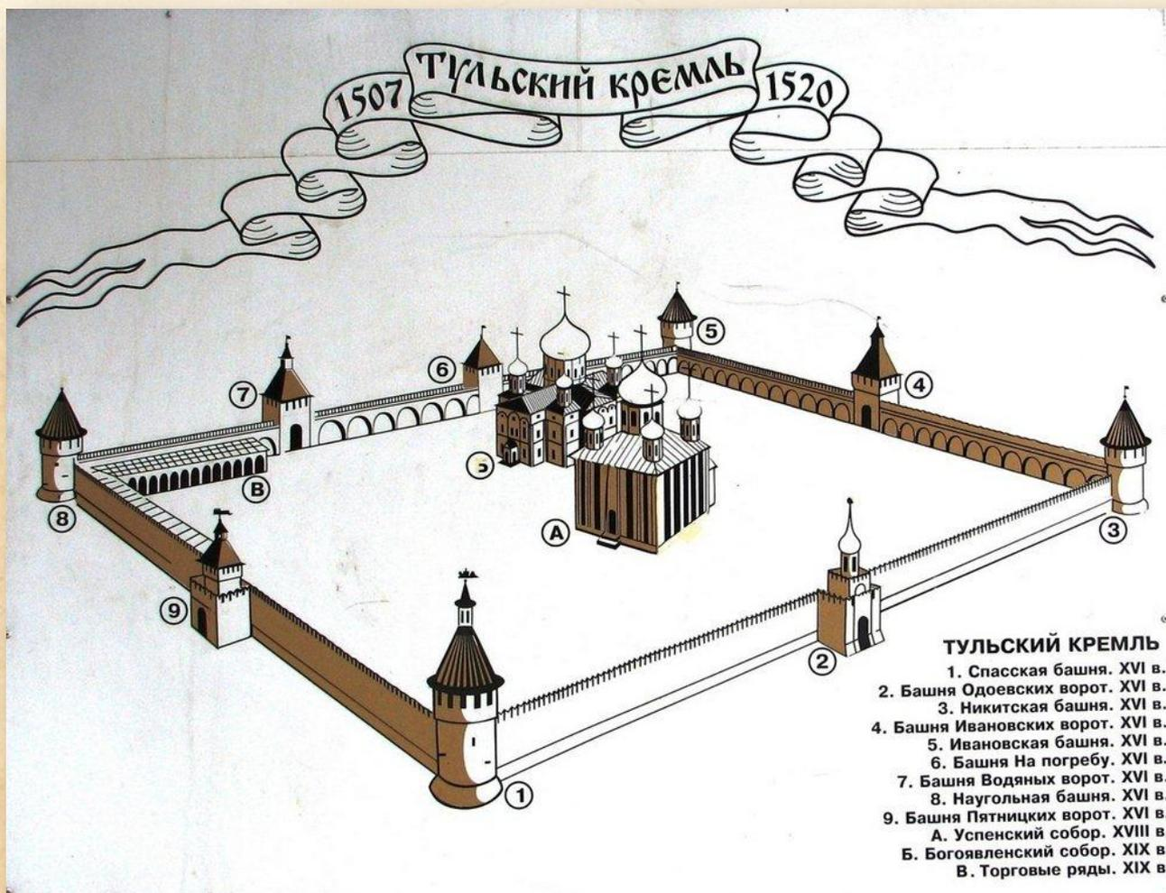
Что касается архитектуры и военно-инженерного отношения, то ни одна из девяти башен не получила главенствующего значения. Все они имеют высокие деревянные шатровые кровли. Высота стен также везде одинаковая: по документам конца XVII века она составляет **10,7 м.**
