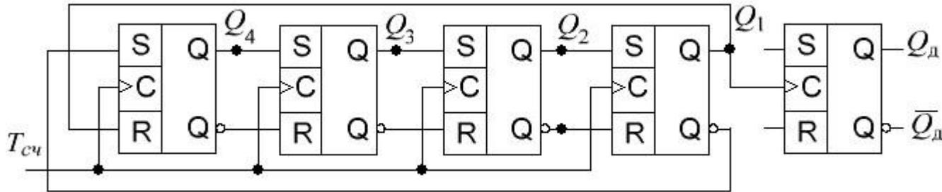
Рисунок 13 - Схема счётчика выполненная по совмещённой схеме
