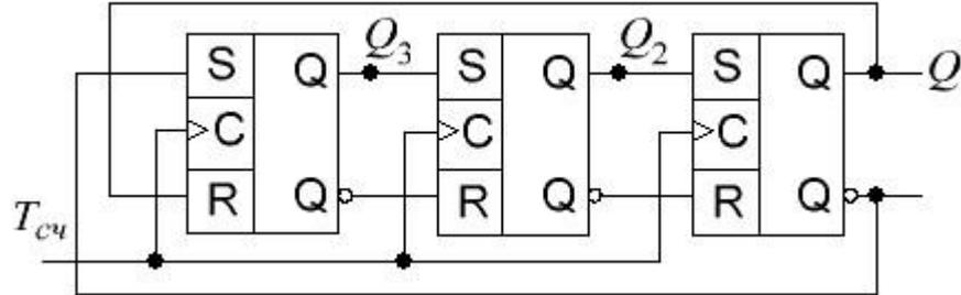
Рисунок 11 - Схемы счётчиков на регистрах с перекрестными связями с  $K_{сч} = 6$
