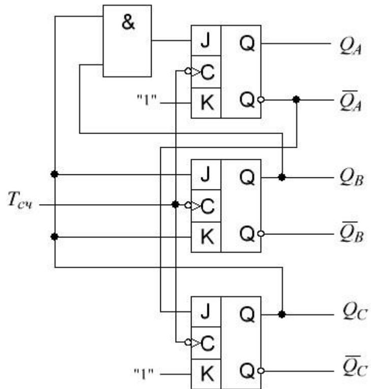
Рисунок 7 - Схема синтезируемого счётчика с  $K_{сч} = 5$  работающий в двоичном коде.
