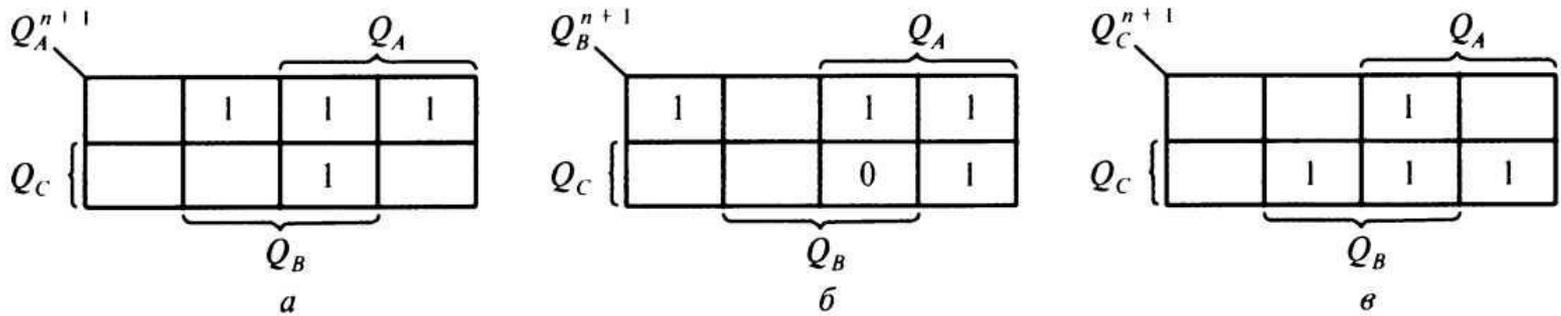
Рисунок 4 - Карты Карно синтезируемого счётчика на восемь состояний: а — для триггера А;
