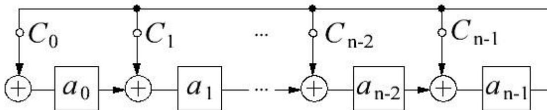
Рисунок 14 - Схема полиномиального счётчика
