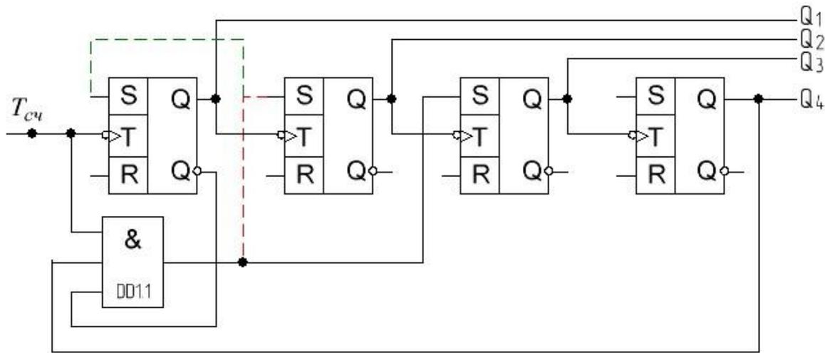
Рисунок 1 - Схема последовательного счётчика
