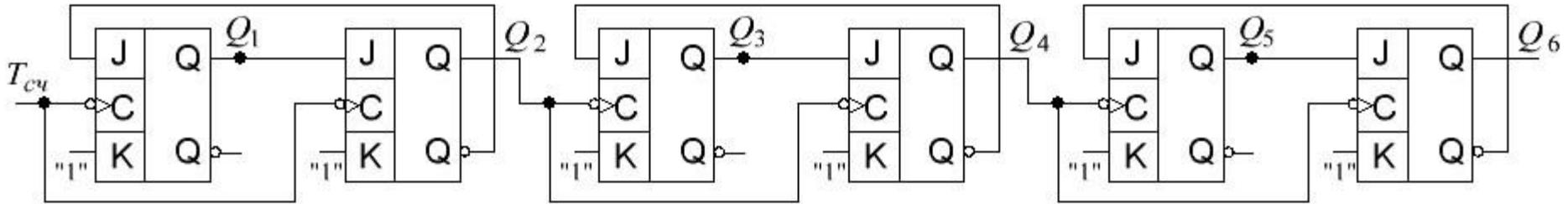
Рисунок 9а - Вариант разбиения счётчика с  $K_{сч} = 27$
