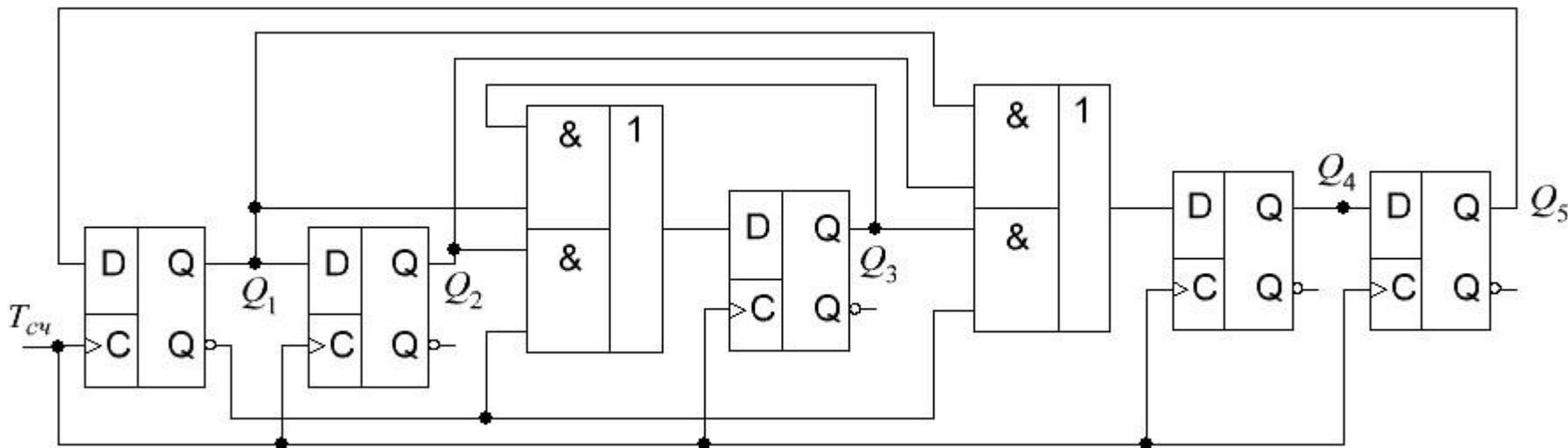
Рисунок 10 – Схема сдвигающего счётчика вида 2/5 с  $K_{сч} = 10$
