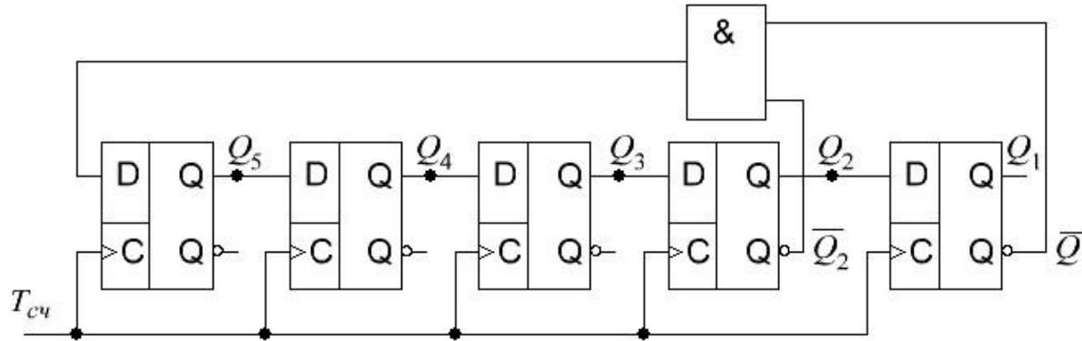
Рисунок 12 - Схемы счётчиков на регистрах с перекрестными связями с  $K_{сч} = 9$
