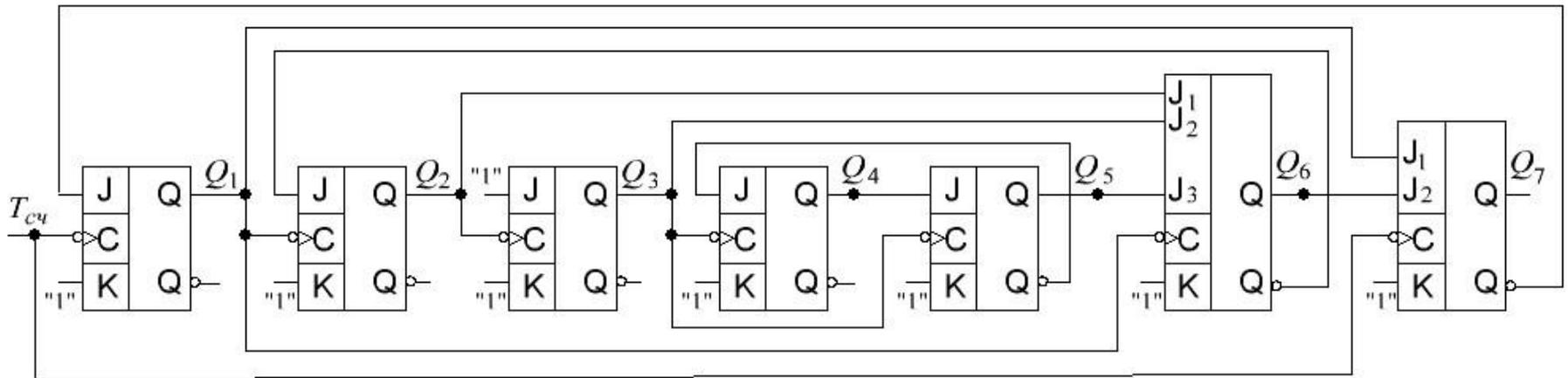
Рисунок 9в - Варианты разбиения счётчика с  $K_{сч} = 27$
