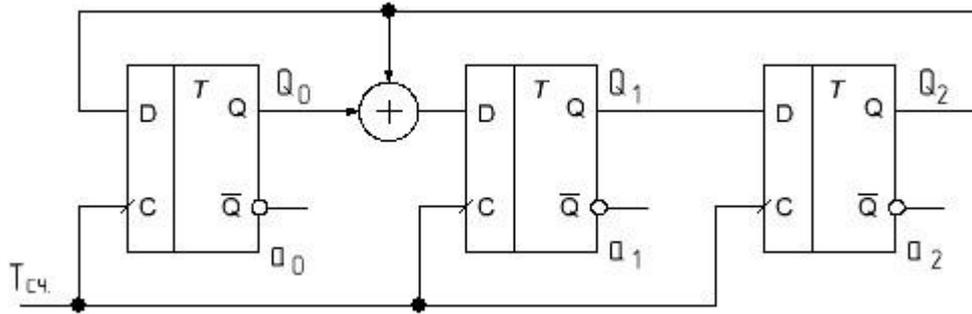
Рисунок 15 - Схема полиномиального счётчика с  $K_{сч} = 7$
