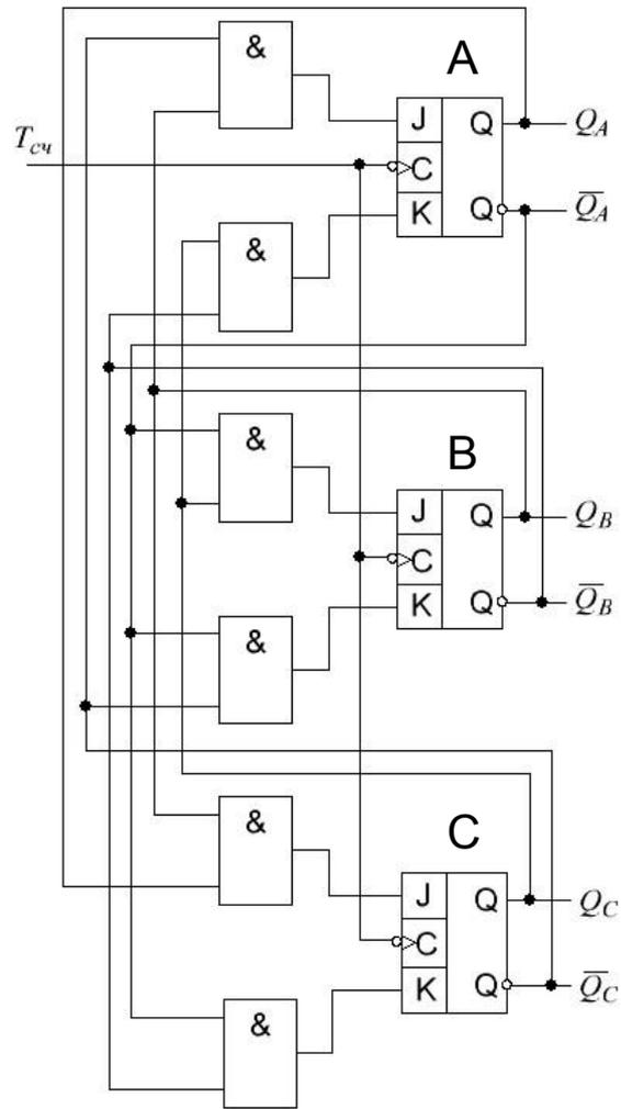
Рисунок 5 - Схема синтезированного счётчика работающего в заданной последовательности (0, 2, 4, 6, 7, 5, 3, 1)→0
