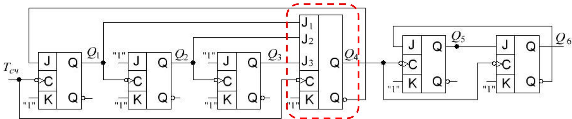
Рисунок 96 - Вариант разбиения счётчика с  $K_{сч} = 27$
