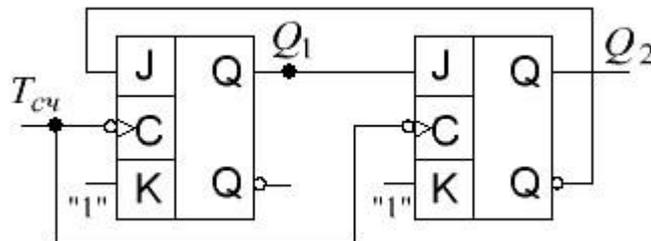
Рисунок 8 – Схема счётчика по модулю 3 на *JK*-триггерах
