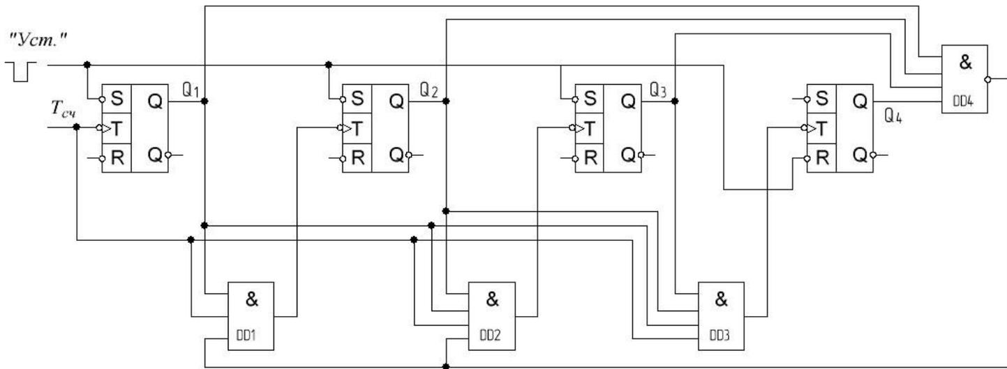
Рисунок 2а - Схема синхронного счётчика с  $K_{сч} = 9$  и начальной установкой кода 7
