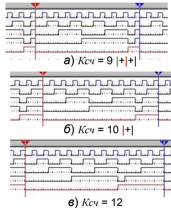
На рисунке 1 показана схема счётчика построенного на  $T$ -триггерах по схеме асинхронного счётчика со последовательным переносом. Счётчик можно настроить на разные коэффициенты счёта:  $K_{сч} = 9$  (а),  $10$  (б),  $12$  (в), Для исключения избыточных состояний чисел:  $7$  (а),  $6$  (б),  $4$  (в), введена обратная связь с выхода элемента DD1.1 на асинхронные входы  $S$  соответствующих разрядов ( $0111_2 \rightarrow 7$ ,  $0110_2 \rightarrow 6$ ,  $0100_2 \rightarrow 4$ ).
