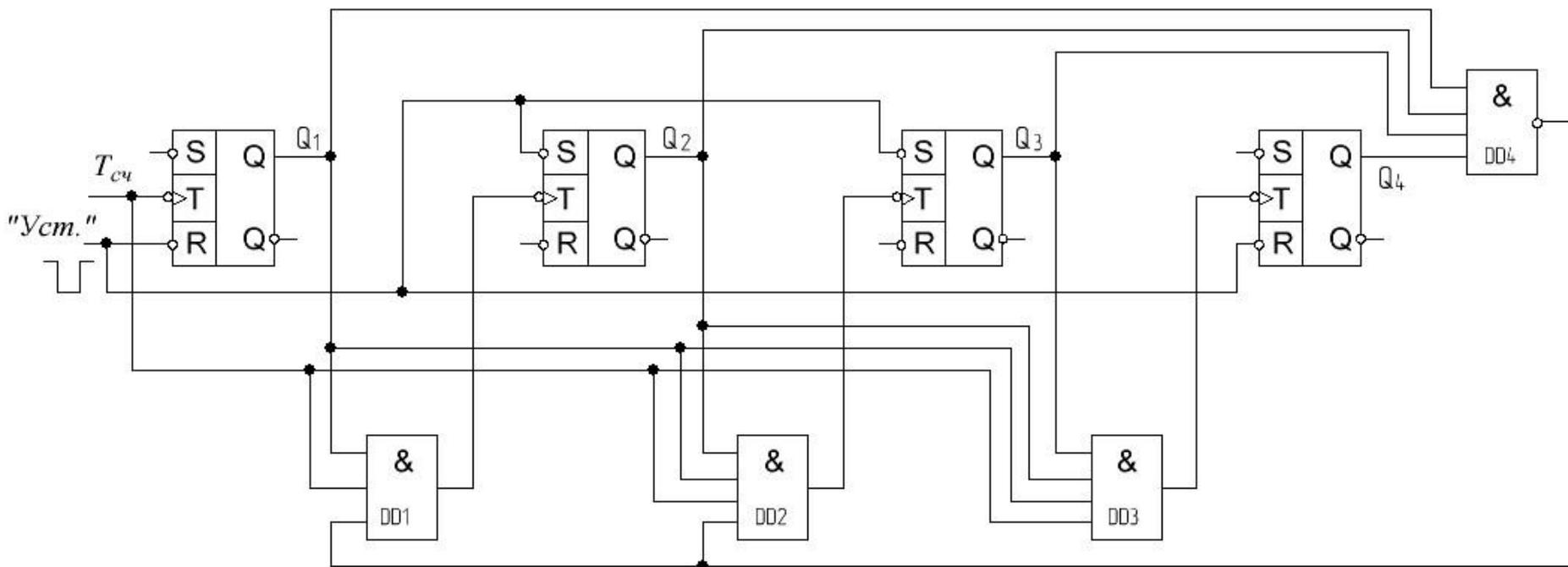
Рисунок 2 - Схема синхронного счётчика с  $K_{сч} = 10$  и начальной установкой кода
