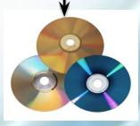
СD-ROM — изготовляются на заводах методом штамповки и является не записываемым носителем данных СD-R— одноразовый записываемый компакт-диск. CD-RW — перезаписываемый (многоразовый) компакт-диск.
