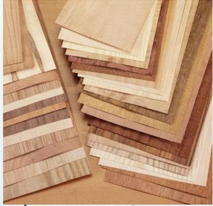
Для мозаичных работ используют шпон из всех пород древесины. Шпон должен быть абсолютно сухим, чтобы не появлялись трещины после приклеивания набора к основе. Для мелких деталей применяют шпон из древесины со слабо выраженной текстурой — липы, груши, берёзы. Для более крупных — шпон из клёна, дуба, ореха, ясеня, вяза, палисандра, карагача и др.
