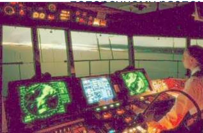
**Ходовой мостик** – огражденная часть палубы ходовой рубки, где расположены приборы управления кораблем и его оружием: машинные телеграфы, репитеры компаса, лага, выносные индикаторы радиолокатора, гидролокатора и др.
