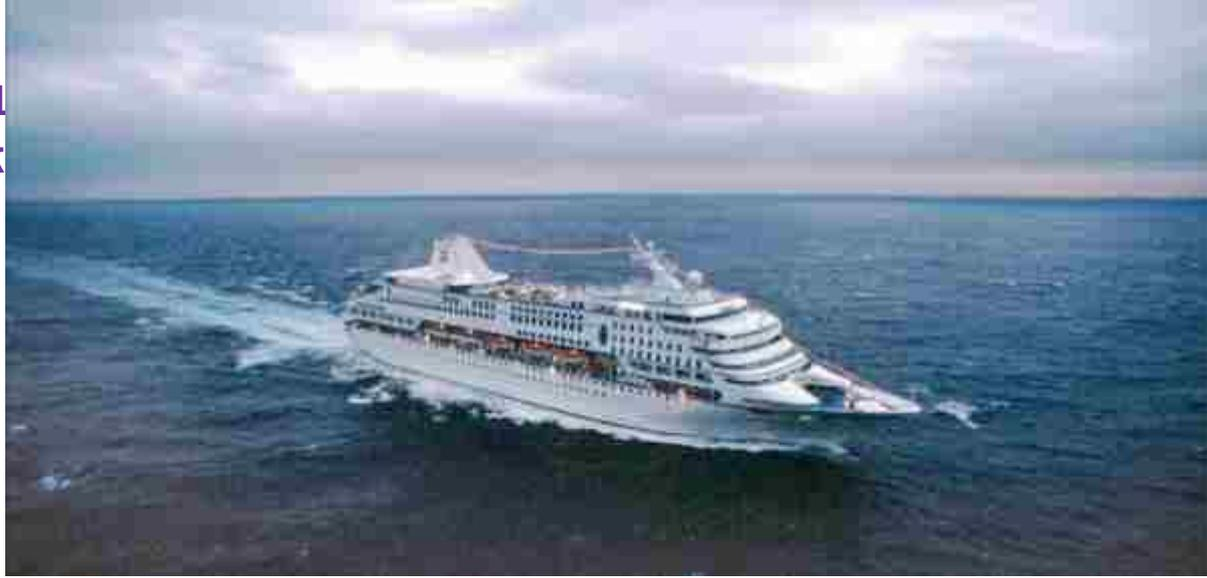
*Пассажирский лайнер. Огромный надводный объем в носовой части корпуса предполагает плавание на волнении со свободным рысканием на курсе, но этого не допускает бульб. Широкая кормовая палуба существенно ограничивает возможности выбора штормового курса. В целом же штормовая безопасность этого судна всецело зависит от надежности двигателей и опытности ходовой вахты или от возможности быстро укрыться от непогоды в ближайшем порту – убежище*
