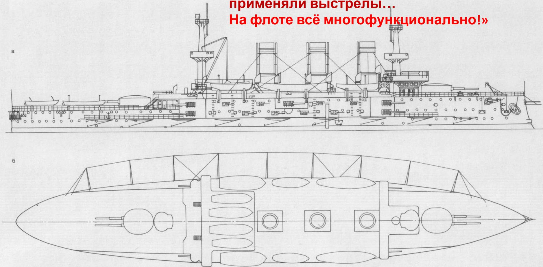
Эскадренный броненосец «Пересвет»: а — вид сбоку; б — общее расположение сетевого заграждения (из фондов РГАВМФ)
