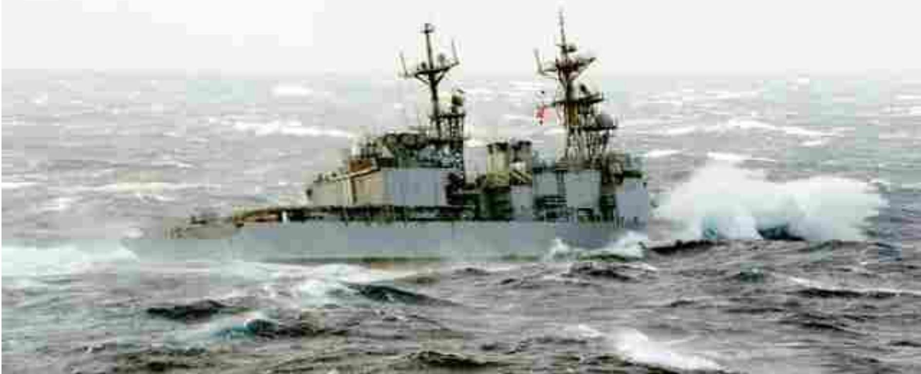
*Характерное положение корпуса движущегося корабля в штормовом море. Носовая часть корпуса активно взаимодействует со встречной волной, оставляя среднюю и кормовую части корпуса в относительно спокойном состоянии.*
