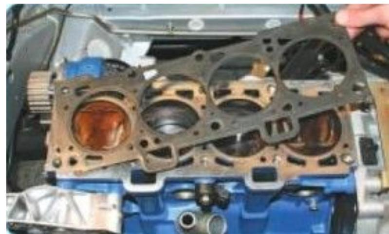
38. Снимите прокладку головки
