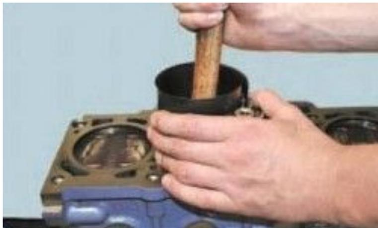
31. Плотно прижмите оправку к блоку и ручкой молотка протолкните поршень в цилиндр. Оправка будет неплотно прилегать к блоку цилиндров, можно поломать поршневые кольца.
