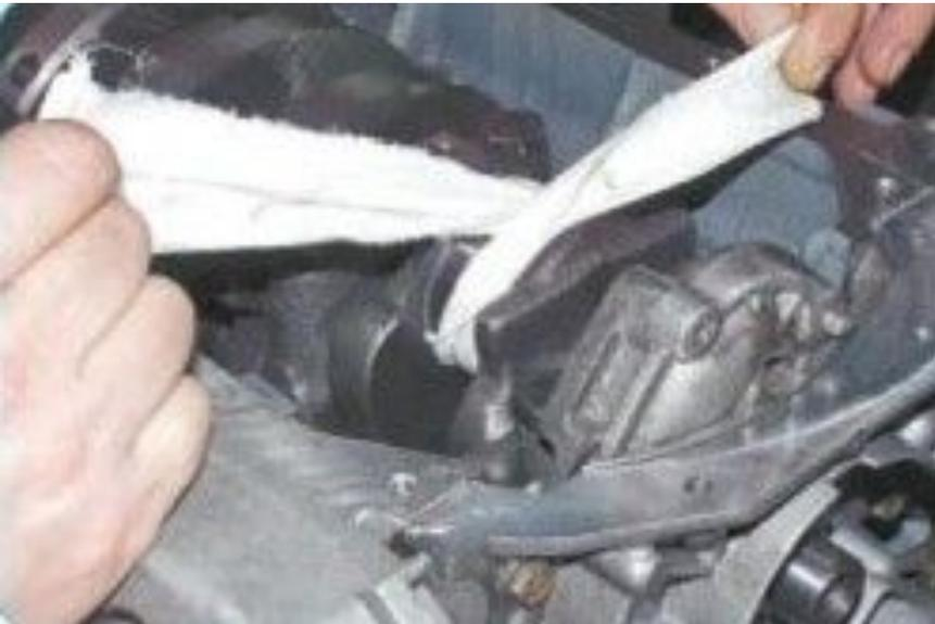
27. Тщательно протрите чистой тряпкой шатунные шейки коленчатого вала.
