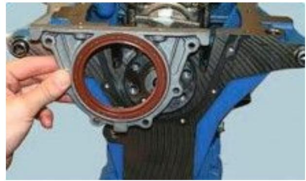
67. Снимите держатель с установленным в нем сальником
