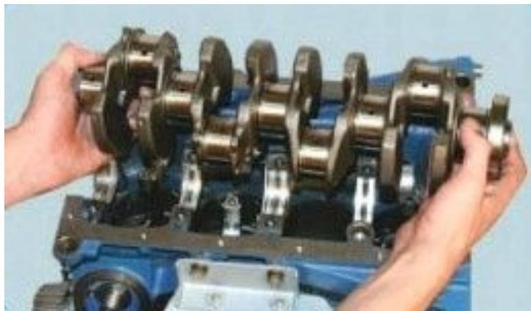
4. Установите коленчатый вал в блок цилиндров
