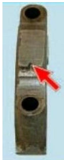
Крышки коренных подшипников промаркированы насечками в соответствии с номерами цилиндров. Если эти метки плохо видны, обязательно дополнительно промаркируйте крышки, чтобы установить их на прежние места: крышки не взаимозаменяемы (блок цилиндров обработан вместе с крышками).
