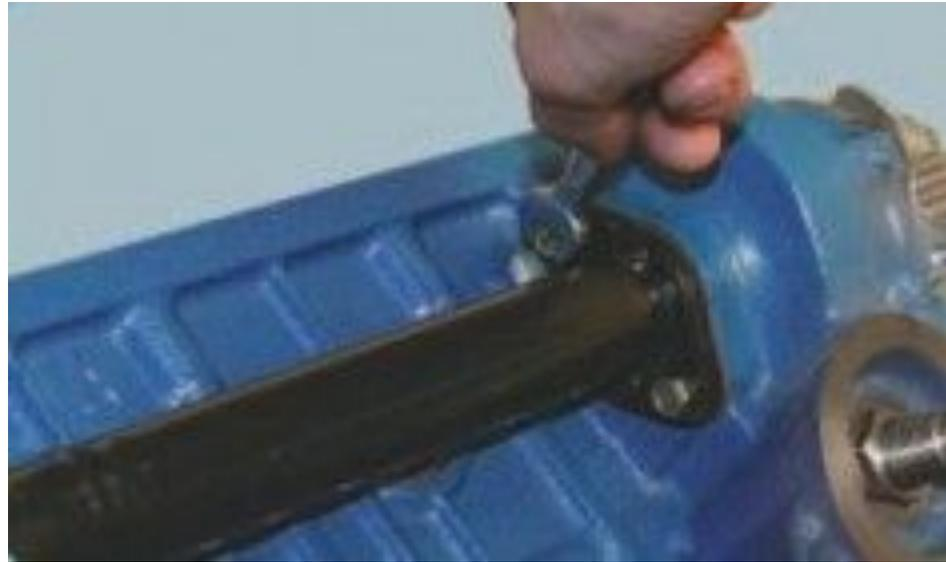
48. Ключом «на 10» выверните два болта крепления подводящей трубы насоса охлаждающей жидкости к блоку цилиндров...
