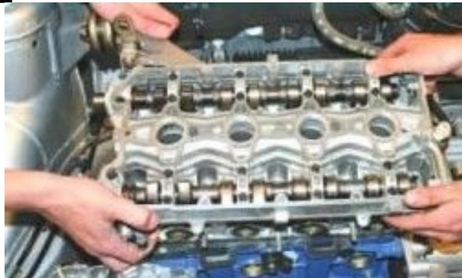
37. Снимите головку блока с двигателя
