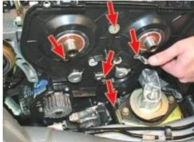
34. Выверните ключом «на 10» пять болтов крепления задней защитной крышки ремня привода газораспределительного механизма.
