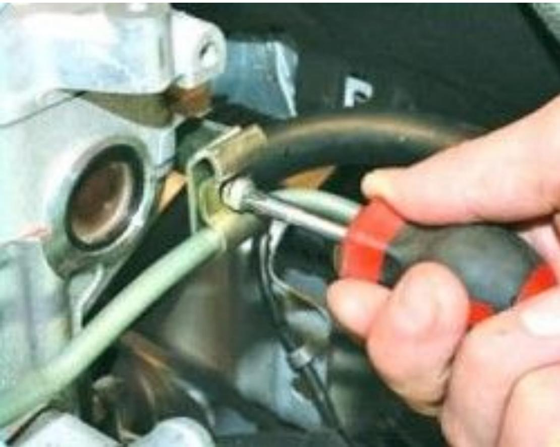
18. Выверните винт прижимной пластины кронштейна крепления топливопровода к головке блока цилиндров и снимите пластину.
