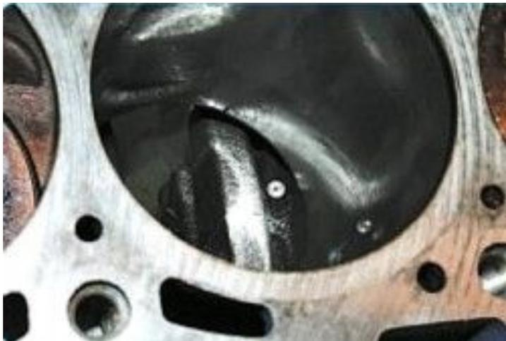
32. Осмотрите цилиндры. Если на зеркале цилиндров есть царапины, задиры, раковины и другие дефекты, расточите цилиндры под ремонтный размер (эту работу рекомендуется выполнять в специализированной мастерской) или замените блок цилиндров. При различных дефектах глубиной более 0,8 мм блок ремонту не подлежит и его надо заменить
