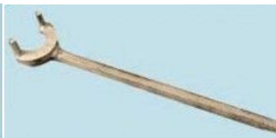
*Для удерживания от проворачивания распределительных валов рекомендуем пользоваться приспособлением, показанным на фото. У шкивов впускного и выпускного распределительных валов одинаковые посадочные размеры, но на шкиве впускного распределительного вала закреплен диск, обеспечивающий работу датчика фаз*
