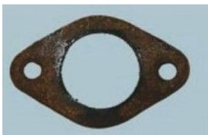
51. При сборке двигателя установите новую уплотнительную прокладку.
