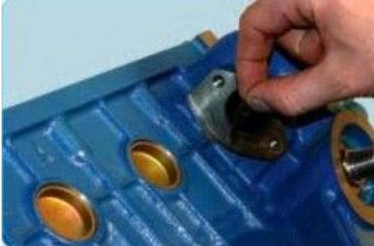
50. Снимите уплотнительную
