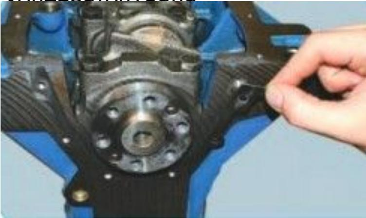
68. Снимите уплотнительную прокладку
