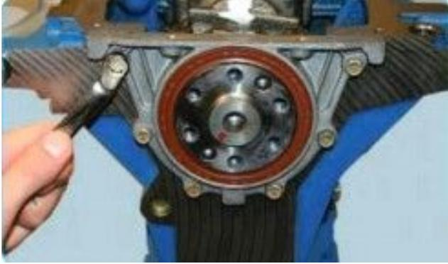
66. Ключом «на 10» выверните шесть болтов крепления держателя заднего сальника коленчатого вала
