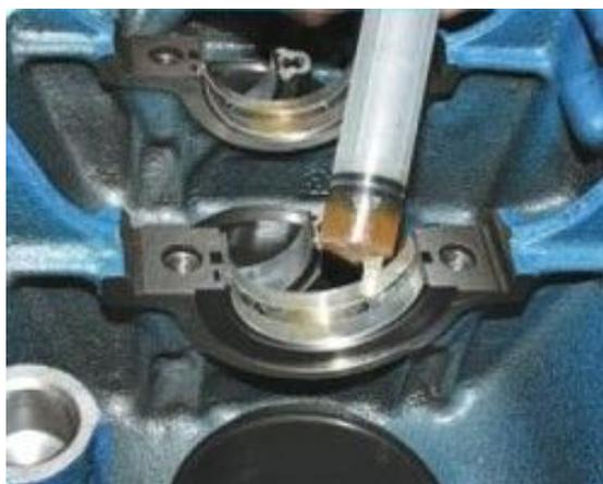
3. Смажьте вкладыши моторным маслом. После установки вкладышей в постели их концы немного выступают наружу, поэтому для правильного ориентирования вкладышей при окончательной затяжке болтов крепления крышек подшипников проследите, чтобы выступание обоих концов было одинаковое.
