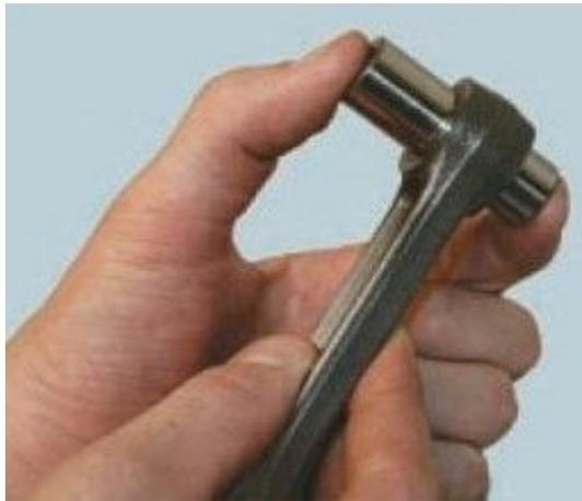
17. Вставьте палец в верхнюю головку шатуна. Если при покачивании пальца ощущается люфт, замените шатун. Шатуны в сборе с крышками по массе верхней и нижней головок разделены на классы.
