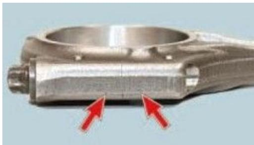
18. В двигатель должны быть установлены шатуны одного класса. Маркировка шатуна нанесена на нижней головке и крышке шатуна.
