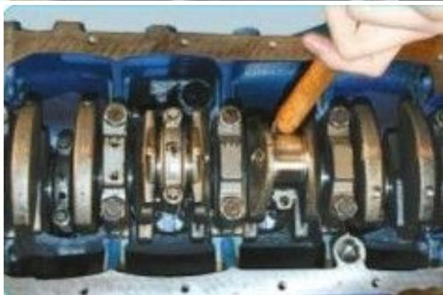
71. Протолкните шатун ручкой молотка внутрь цилиндра
