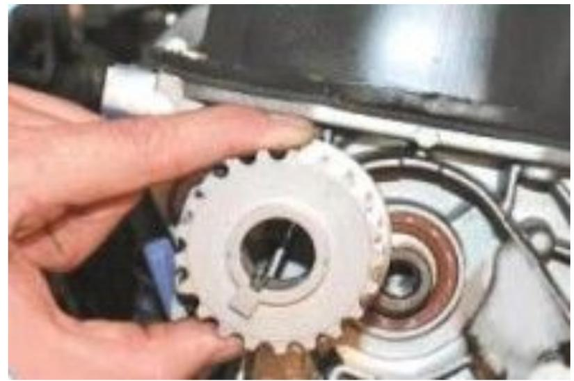
63. Снимите зубчатый шкив с носка коленчатого ва
