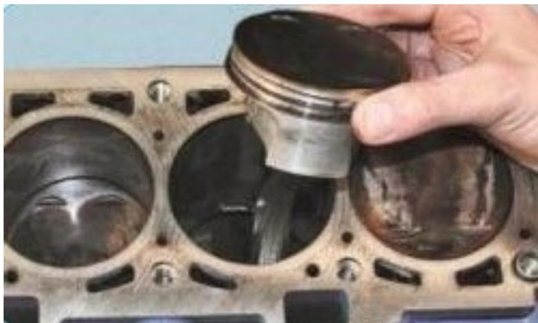
72 Вынуть поршень из цилиндра. При этом следите за тем, чтобы нижняя головка шатуна не касалась зеркала цилиндра, иначе можно повредить зеркало.
