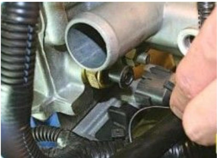
14. Отсоедините колодку жгута проводов от датчика указателя температуры охлаждающей жидкости.
