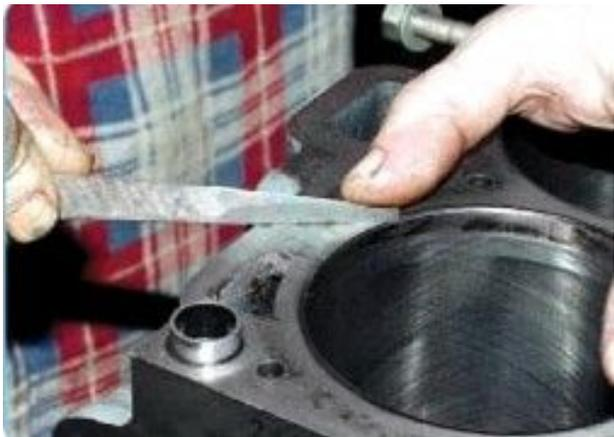
30. Тщательно очистите поверхности блока цилиндров от остатков старых уплотнительных прокладок. Внимательно осмотрите блок. Если обнаружите трещины, блок надо заменить в сборе с крышками коренных подшипников.
