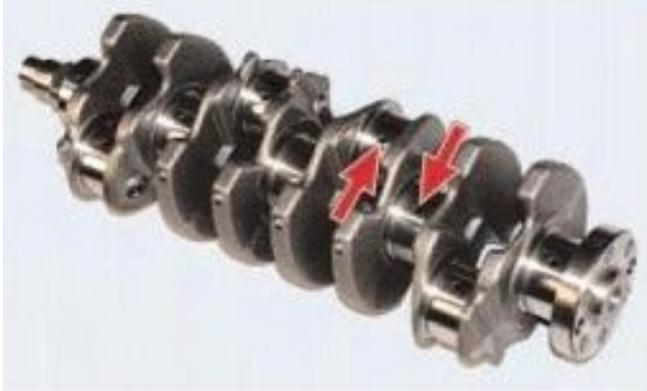
28. Тщательно прочистите и промойте масляные каналы коленчатого вала.
