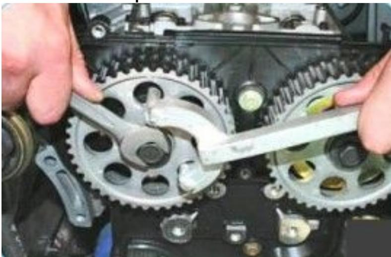
29. Удерживая шкивы распределительных валов от проворачивания, выверните болты крепления шкивов
