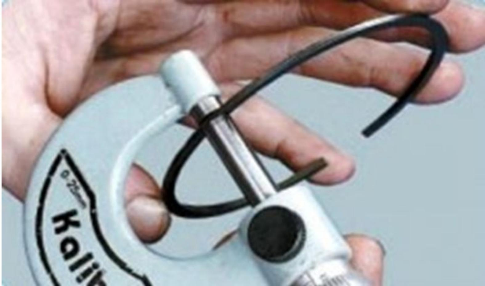
4. Наиболее точно зазоры можно определить замером колец и канавок на поршне. Для этого замерьте микрометром толщину колец в нескольких местах по окружности, затем с помощью набора щупов замерьте ширину канавок также в нескольких местах по окружности. Вычислите средние значения зазоров (разница между толщиной кольца и шириной канавки). Если хотя бы один из зазоров превышает предельно допустимый, замените поршень с кольцами.
