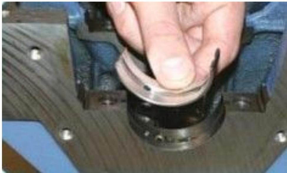
77. Выньте вкладыши из крышек коренных подшипников
