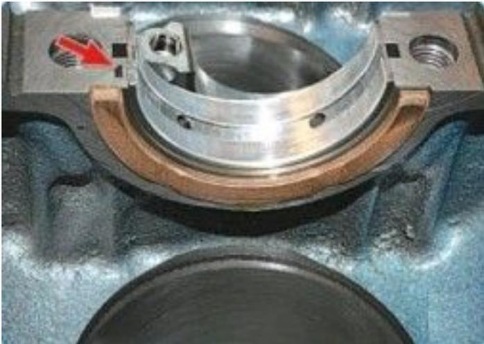
2. Установите вкладыши коренных подшипников в постели блока цилиндров в соответствии с метками, сделанными при разборке. При установке вкладышей их стопорные усики должны войти в пазы постелей.
