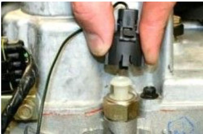
10. Отсоедините колодку жгута проводов от датчика аварийного падения давления масла...
