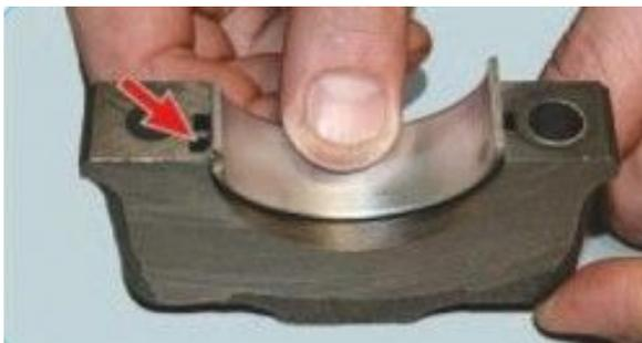
9. Вставьте вкладыши в крышки коренных подшипников в соответствии с метками, сделанными при разборке. При этом стопорные усики вкладышей должны войти в пазы крышек
