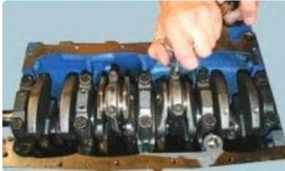
69. Поверните коленчатый вал так, чтобы снимаемый поршень был в НМТ (нижней мертвой точке). Ключом TORX E10 отверните два болта крепления крышки шатуна.
