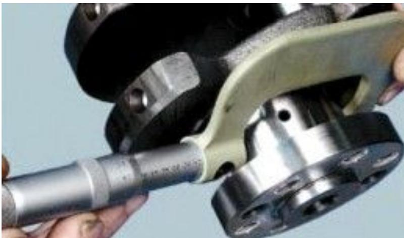
20. Измерьте коренные и шатунные шейки коленчатого вала.
