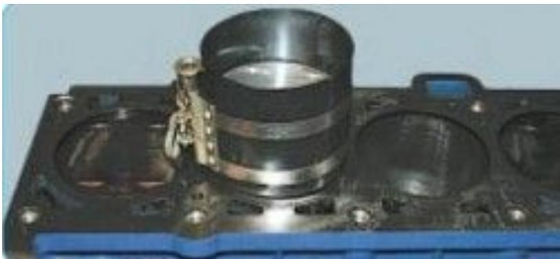
30. Наденьте на поршень специальную оправку для сжатия поршневых колец и аккуратно опустите шатун в цилиндр. Рекомендуется предварительно повернуть коленчатый вал так, чтобы его шатунная шейка, на которую монтируют шатунно-поршневую группу, установилась в НМТ. Стрелка на днище поршня должна быть направлена к передней части двигателя (в сторону привода распределительного вала).
