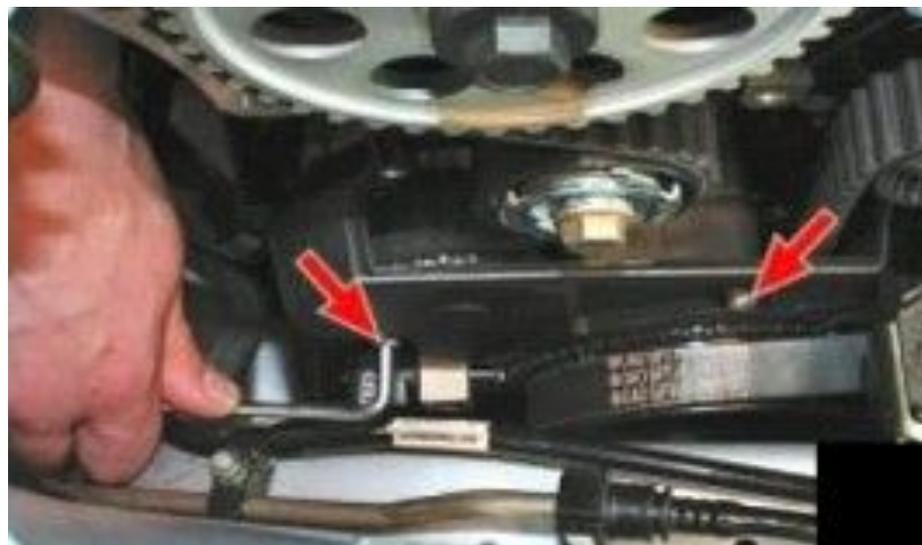
25. Шестигранным ключом «на 5» выверните болты крепления нижней передней крышки ремня привода газораспределительного механизма...
