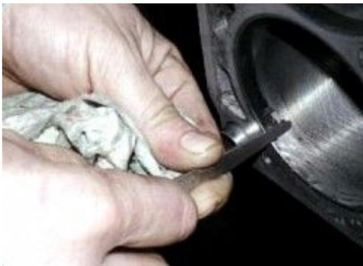
33. Очистите нагар в верхней части цилиндров. Если там образовался поясok вследствие износа цилиндров, снимите его шабером.
