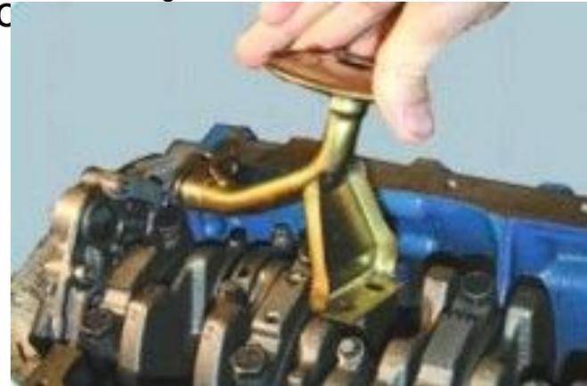
61. Снимите маслоприемник. Обратите внимание: в проточке патрубка приемника установлено резиновое уплотнительное кольцо. Сильно надорванное кольцо обязательно заменить
