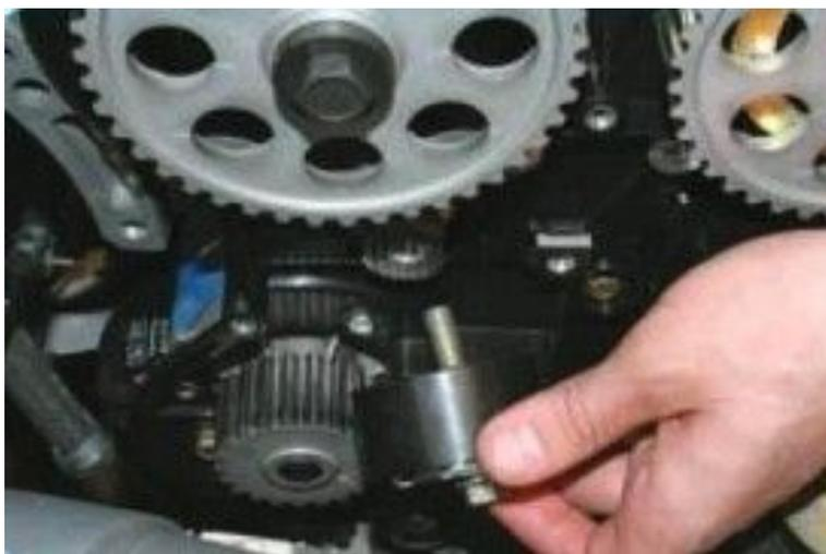
32. Вывернув ключом «на 15» болт крепления, снимите натяжной ролик.
