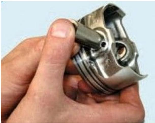
13. Пальцы с трещинами замените. Палец должен легко входить в поршень от усилия большого пальца руки. Вставьте палец в поршень. Если при покачивании пальца ощущается люфт, замените поршень. При замене поршня подберите к нему палец по классу.
