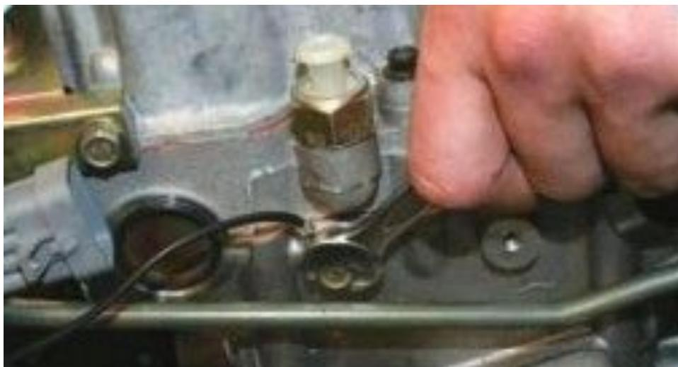
19 Выверните ключом «на 10» болт крепления
