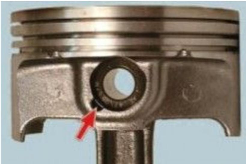
19. Смажьте поршневой палец моторным маслом и вставьте палец в Сборка двигателя ВАЗ-21126 поршень и шатун.
