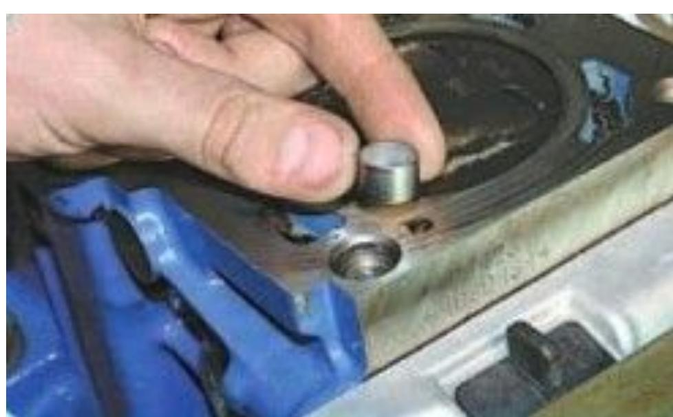
41. Проверьте наличие двух установочных втулок в гнездах крайних отверстий блока цилиндров под болты крепления головки. Если при снятии головки втулки остались в головке или вышли из гнезд блока, запрессуйте их в блок до упора.
