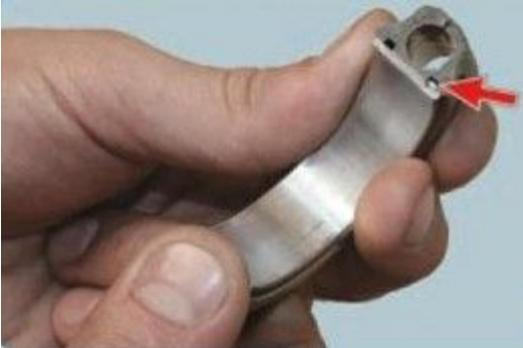
33. Вставьте вкладыш в крышку шатуна в соответствии с ранее сделанными метками так, чтобы усик вкладыша вошел в проточку в крышке. После этого смажьте вкладыш моторным маслом.
