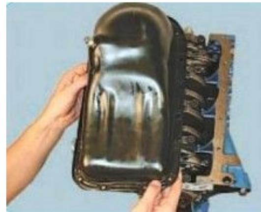
59. Снимите масляный картер вместе с уплотнительной прс
