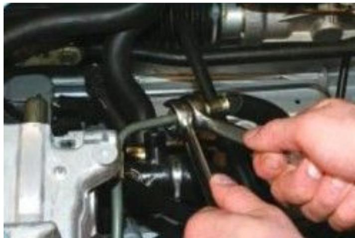
17. Отверните гайку штуцера топливного шланга и отсоедините его от трубки топливопровода.
