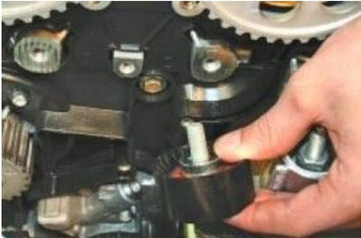
33. Вывернув ключом «на 15» болт крепления, снимите опорный
