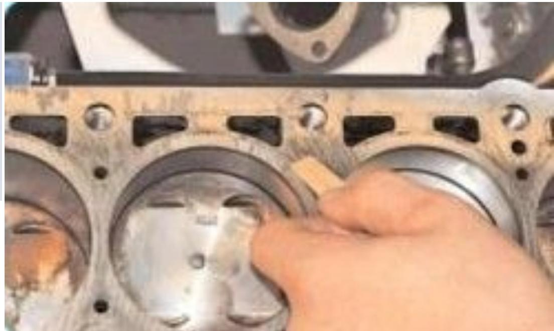
Болты крепления головки блока цилиндров вытягиваются при многократном использовании. Болты, длина которых (без учета высоты головки) превышает 98 мм, замените новыми. Перед установкой головки блока смажьте болты тонким слоем моторного масла.
