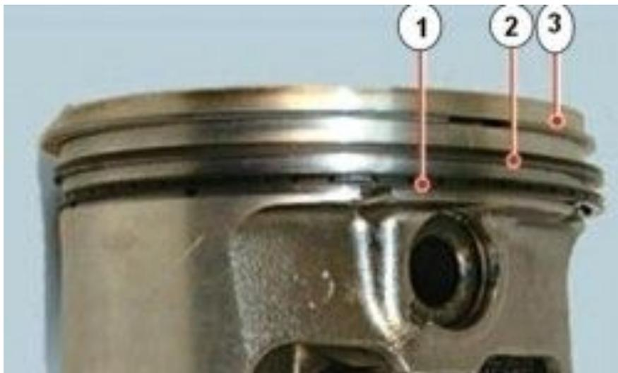
21. Установите на поршень расширитель маслосъемного кольца.
