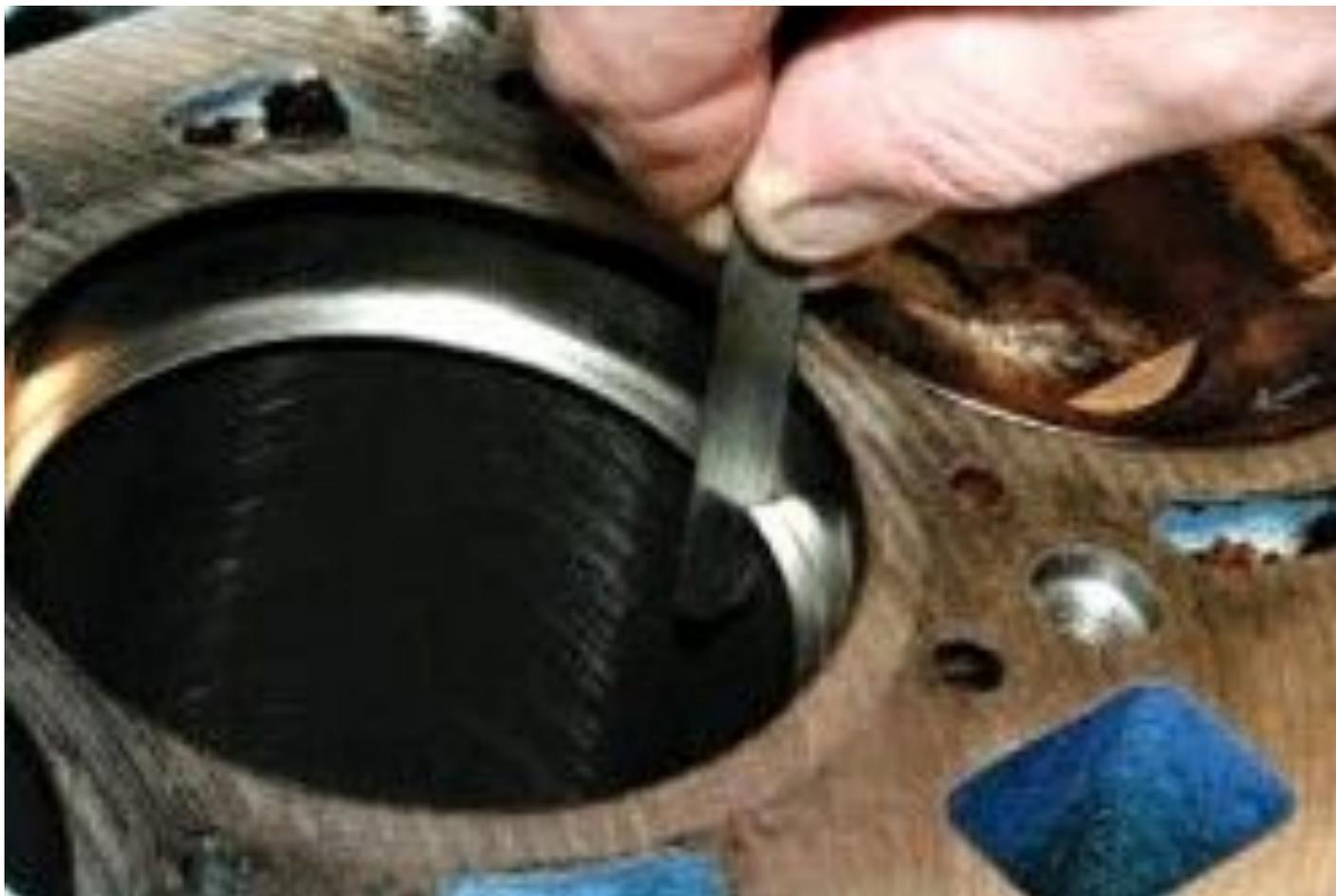
5. Измерьте зазоры в замках колец, вставив кольцо в специальную оправку. При отсутствии оправки вставьте кольцо в цилиндр, в котором оно работало (или будет работать, если кольцо новое), продвиньте поршнем как оправкой кольцо в цилиндр, чтобы оно установилось в цилиндре ровно, без перекосов и измерьте щупом зазор в замке кольца. Номинальный зазор должен быть 0,25–0,45 мм, предельно допустимый (в результате износа) – 1,0 мм. Если зазор превышает предельно допустимый, замените кольцо.
