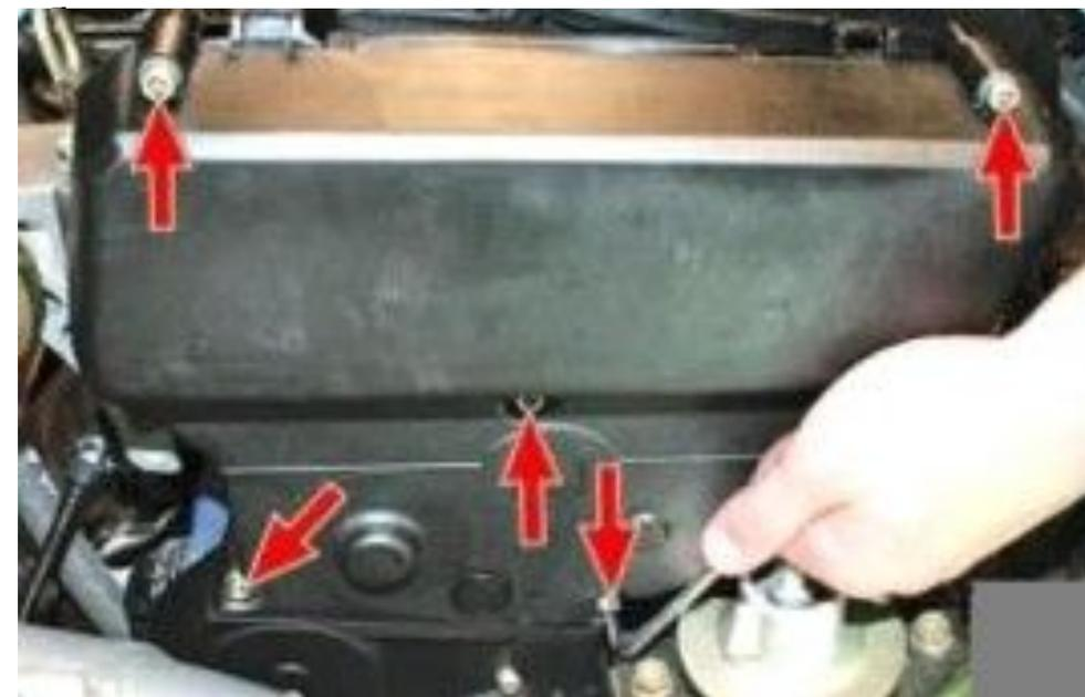
23. Выверните шестигранным ключом «на 5» болты крепления и снимите переднюю защитную крышку ремня привода газораспределительного механизма
