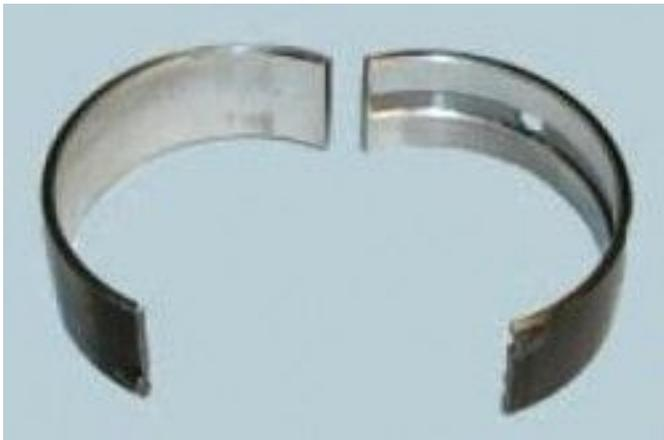
25. Осмотрите шатунные и коренные вкладыши. Замените вкладыши с трещинами, задирами, выкрашиванием.
