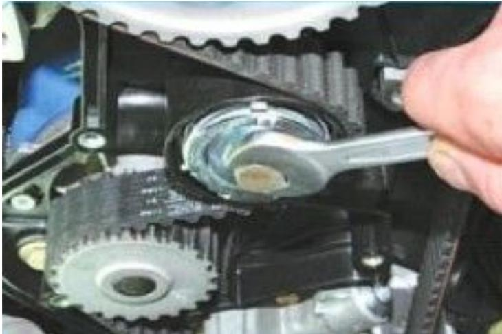
27. Ослабьте ключом «на 15» болт крепления натяжного ролика...
