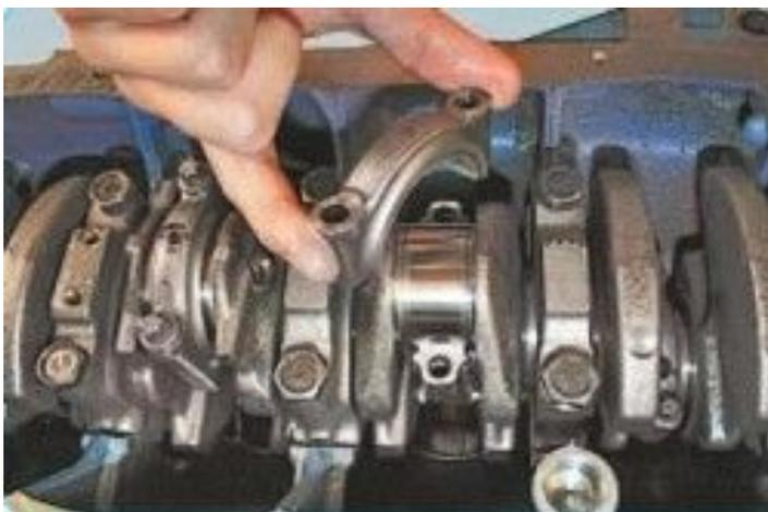
70. Снимите крышку шатуна. Если демонтаж крышки затруднен, предварительно стоньте ее несильными ударами молотка. Номер цилиндра на крышке может быть не виден, в этом случае промаркируйте крышку номером цилиндра.
