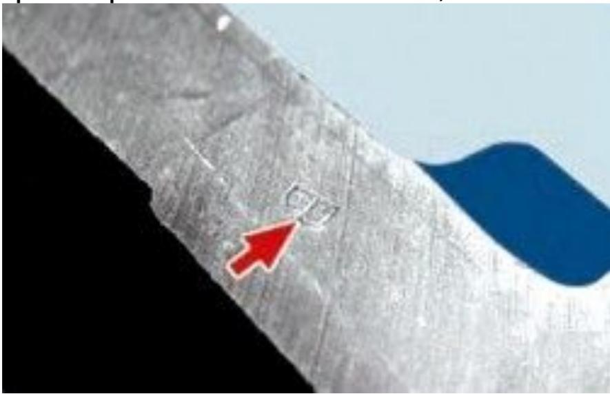
11. Обозначения класса цилиндров выбиты на нижней плоскости блока (привалочная поверхность под масляный картер) напротив каждого цилиндра
