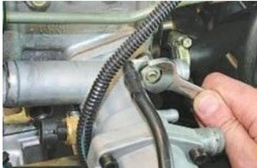
15. Отверните ключом «на 13» гайку крепления наконечника «массового» провода
