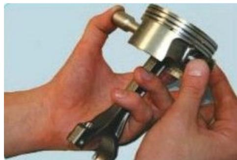
82. С помощью подходящей оправки вытолкните палец из поршня и снимите поршень с шатуна.
