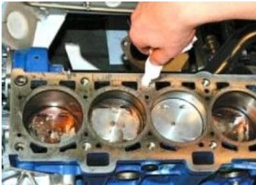
40. Удалите масло из резьбовых отверстий в блоке под болты крепления головки. Если не удалить масло из резьбовых отверстий под болты крепления головки блока, при затяжке болтов в блоке цилиндров могут появиться трещины, так как масло не сжимается.
