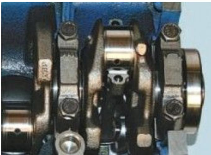
32. Установите нижнюю головку шатуна на шейку коленчатого вала.
