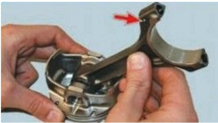
18. Вставьте шатун в поршень в соответствии с ранее сделанными метками так, чтобы номер метка на шатуне была обращена в сторону передней части поршня (в эту сторону направлена стрелка, выбитая сверху на днище поршня).
