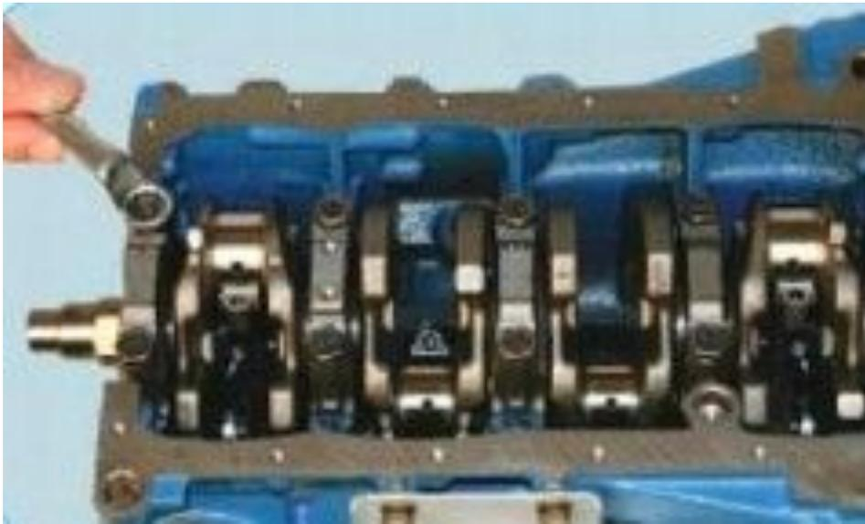
73. Ключом «на 17» выверните по два болта крепления пяти крышек коренных подшипников
