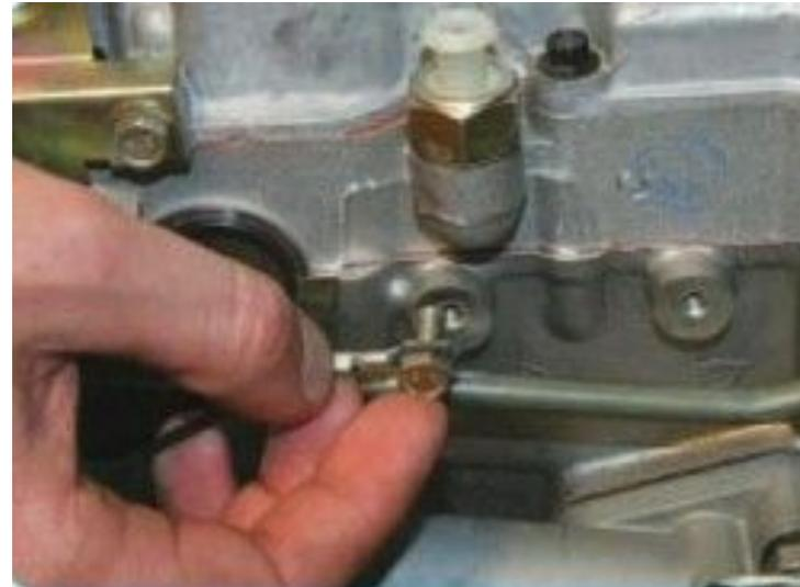
20. Отсоедините «массовый» провод от головки блока.
