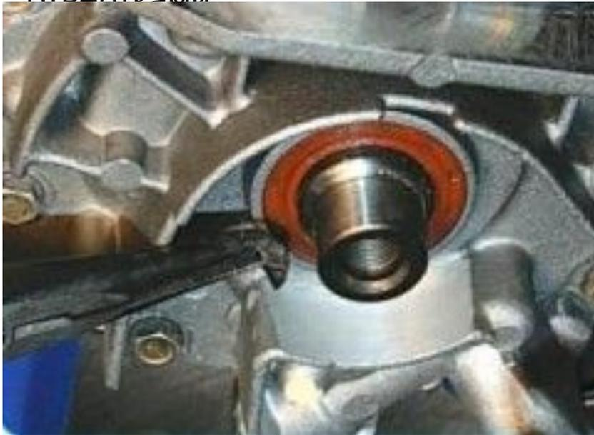
64. Выньте шпонку из паза на носке коленчатого вала.
