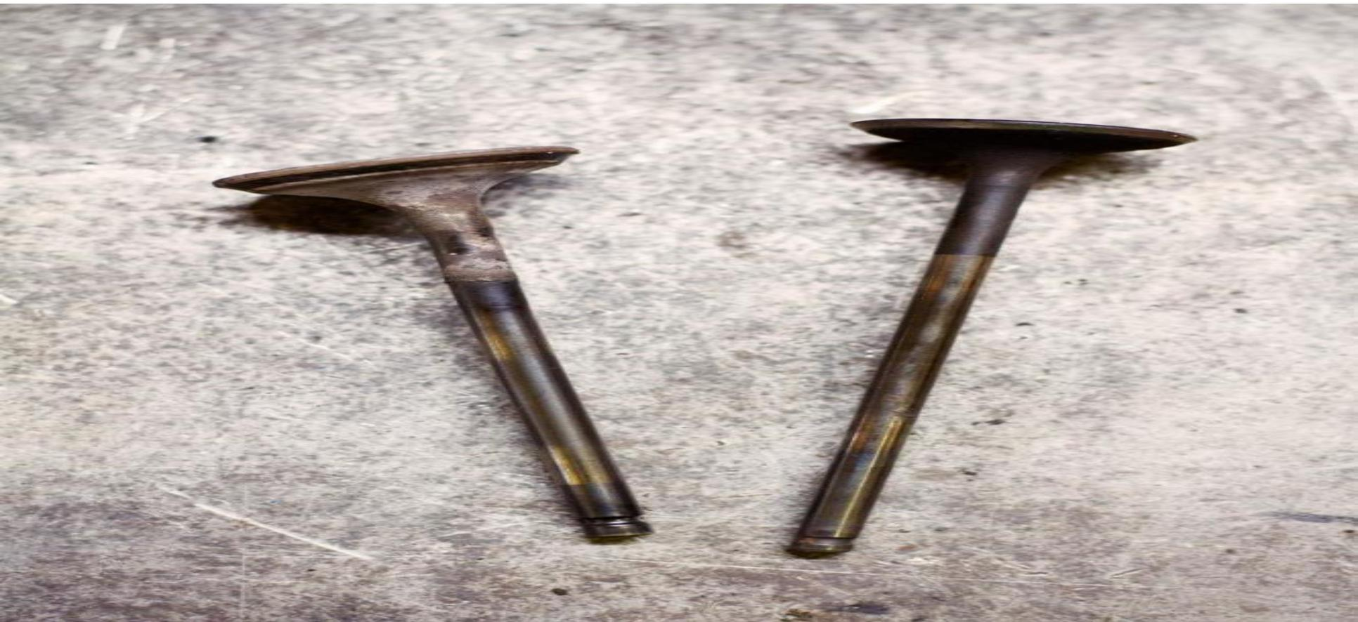
Прогар клапанов, прогар седел клапанов, выпадение седла клапана, износ направляющей втулки клапана и самого стержня клапана по диаметру, погнутые клапаны, и плохо притертые.
