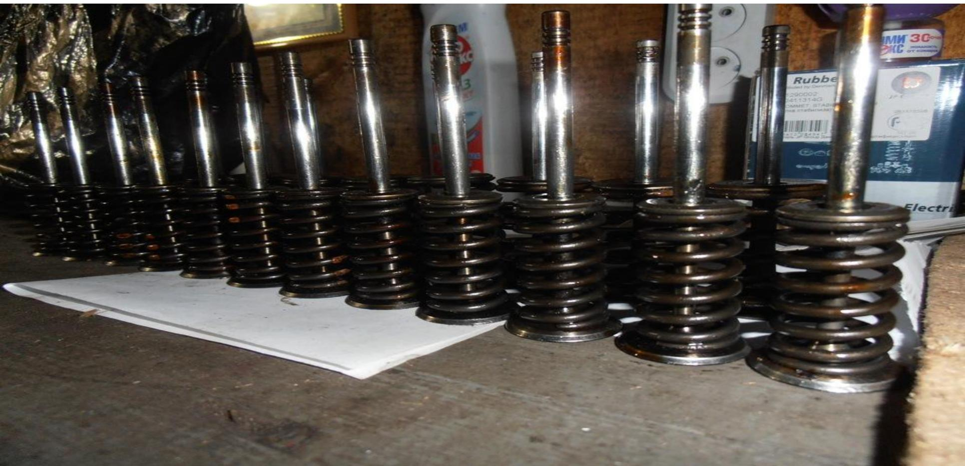
Клапаны (впускной клапан, выпускной клапан) – детали двигателя, служащие для периодического открывания и закрывания отверстий впускных и выпускных каналов в зависимости от положения поршней в цилиндре и от порядка работы двигателя.
