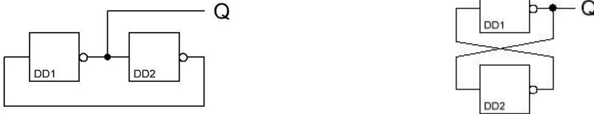
Рисунок 5 - Триггер это простейшая последовательностная схема
