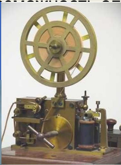
Первый радиоприемник А. С. Попова, конец XIX в.
