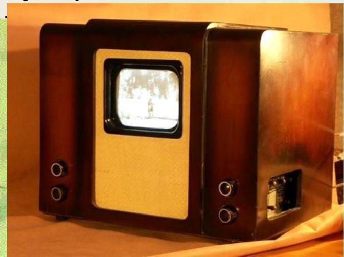
телевизор «Б-2», размер экрана 3х4 см. 1933-1936 гг.
