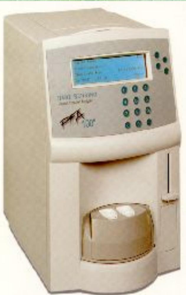
**Датчик тромбоэластографа RFA-100 содержит капилляр, моделирующий микрососуд. В цельной крови, проходящей по капилляру, активируется образование сгустка. На стенках нанесен коллаген и адреналин или АДФ, которые являются первичной причиной запуска гемостаза.**
