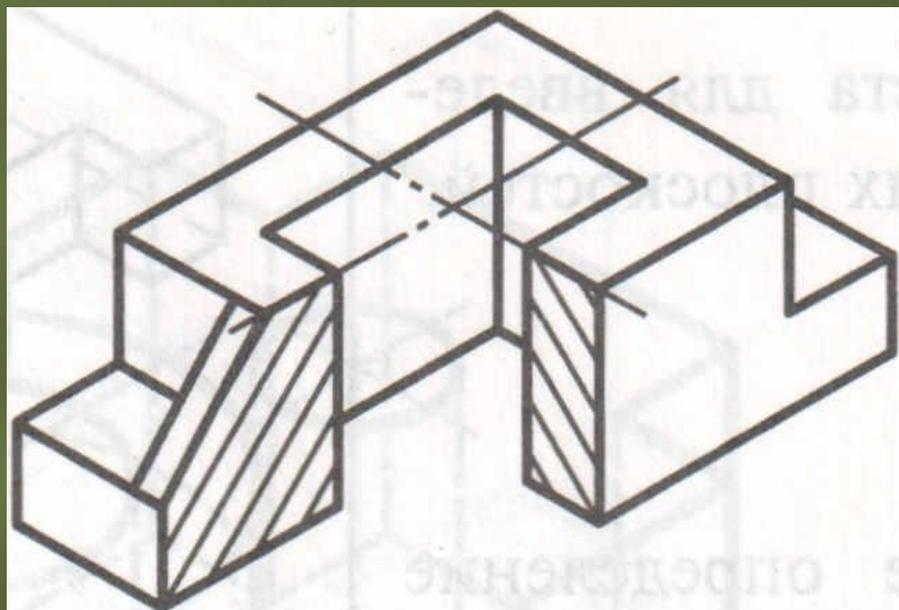
Если деталь имеет одну плоскость симметрии, то одна секущая плоскость совпадает с ней, а другая направляется вдоль оси симметрии одного из элементов детали
