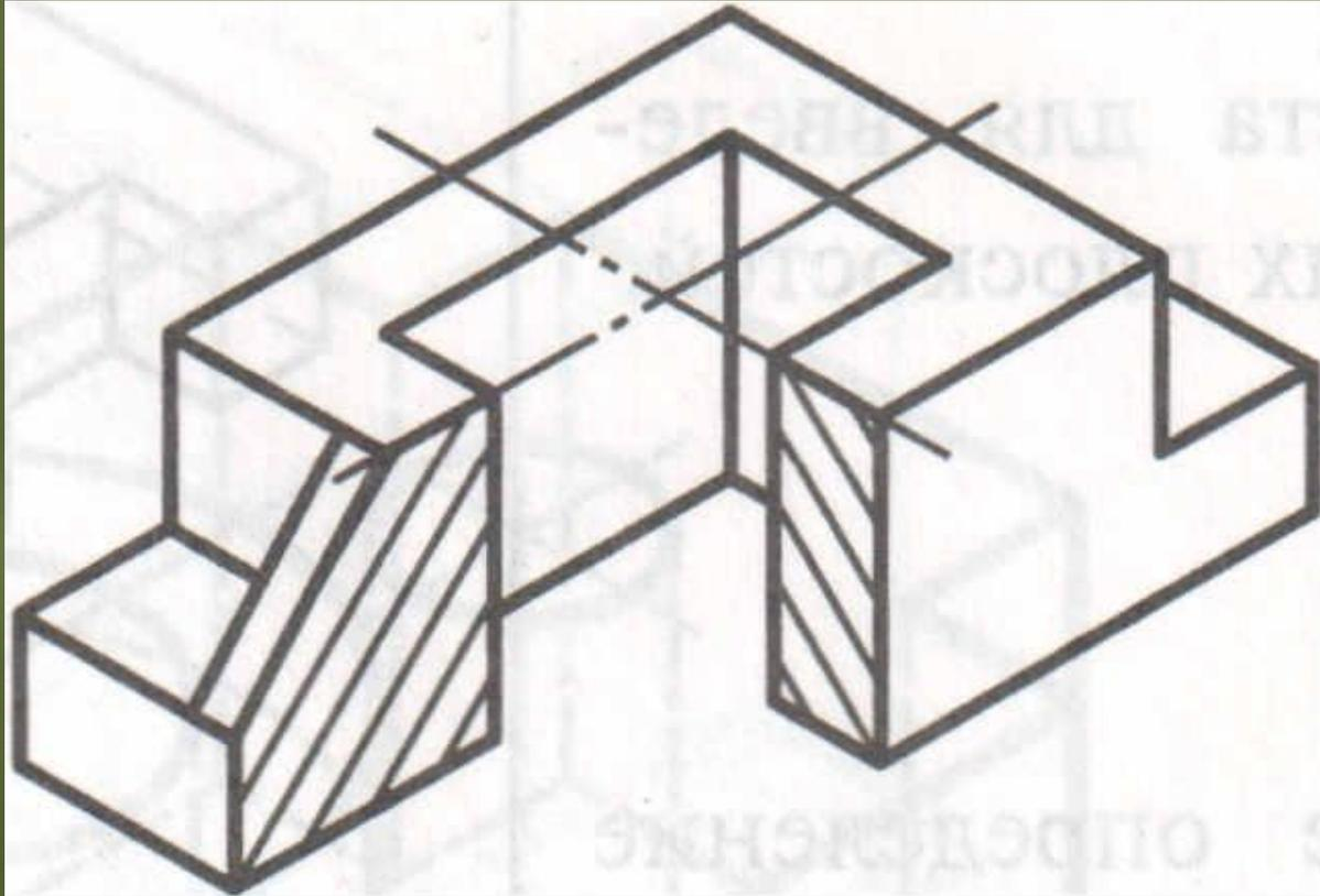
Линии штриховки сечений наносят параллельно диагоналям проекций квадратов, построенных на осях координат
