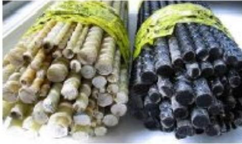
Композиты в 3 раза прочнее и в 4 раза легче изделий из стали
