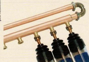
↑ Коаксиальная трубка с теплоносителем, соединенная с абсорбером, расположена внутри стеклянной трубы. В трубе создан вакуум, благодаря этому значительно снижаются теплопотери, а эффективность – возрастает
