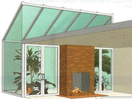
в массивную стену, аккумулирующую тепло, можно встроить камин
