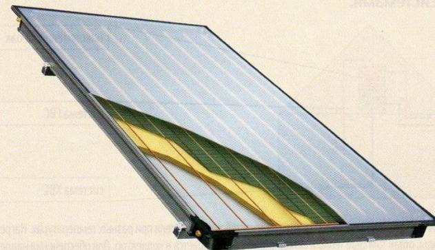
↑ В плоском коллекторе абсорбер, окрашенный в черный цвет, поглощая солнечное излучение, нагревается и нагревает теплоноситель, протекающий по медным трубкам
