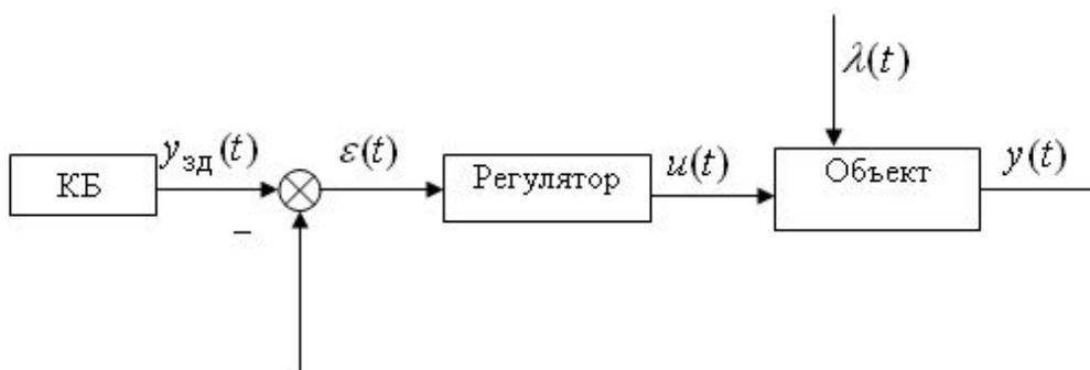
КБ – командный блок, вырабатывающий сигнал задания  $y_{зд}(t)$ ;  $\varepsilon(t)$  – сигнал ошибки управления;  $u(t)$  – управляющее воздействие на объект;  $y(t)$  – выходной сигнал объекта (управляемая величина);  $\lambda(t)$  – возмущающее воздействие.
