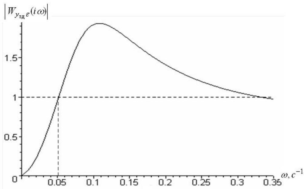
Интервал частот  $\omega$ , в котором замкнутая система обладает фильтрующими свойствами, т.е. ослабляет действующее на нее возмущение  $\lambda(t)$ , определяется неравенством  $0 \leq \omega < 0,05 \text{ с.}^{-1}$  (7)
