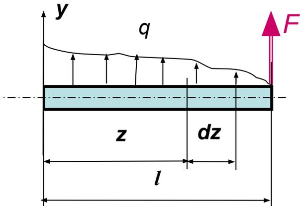
Рассмотрим консольную балку, испытывающую поперечный изгиб.
