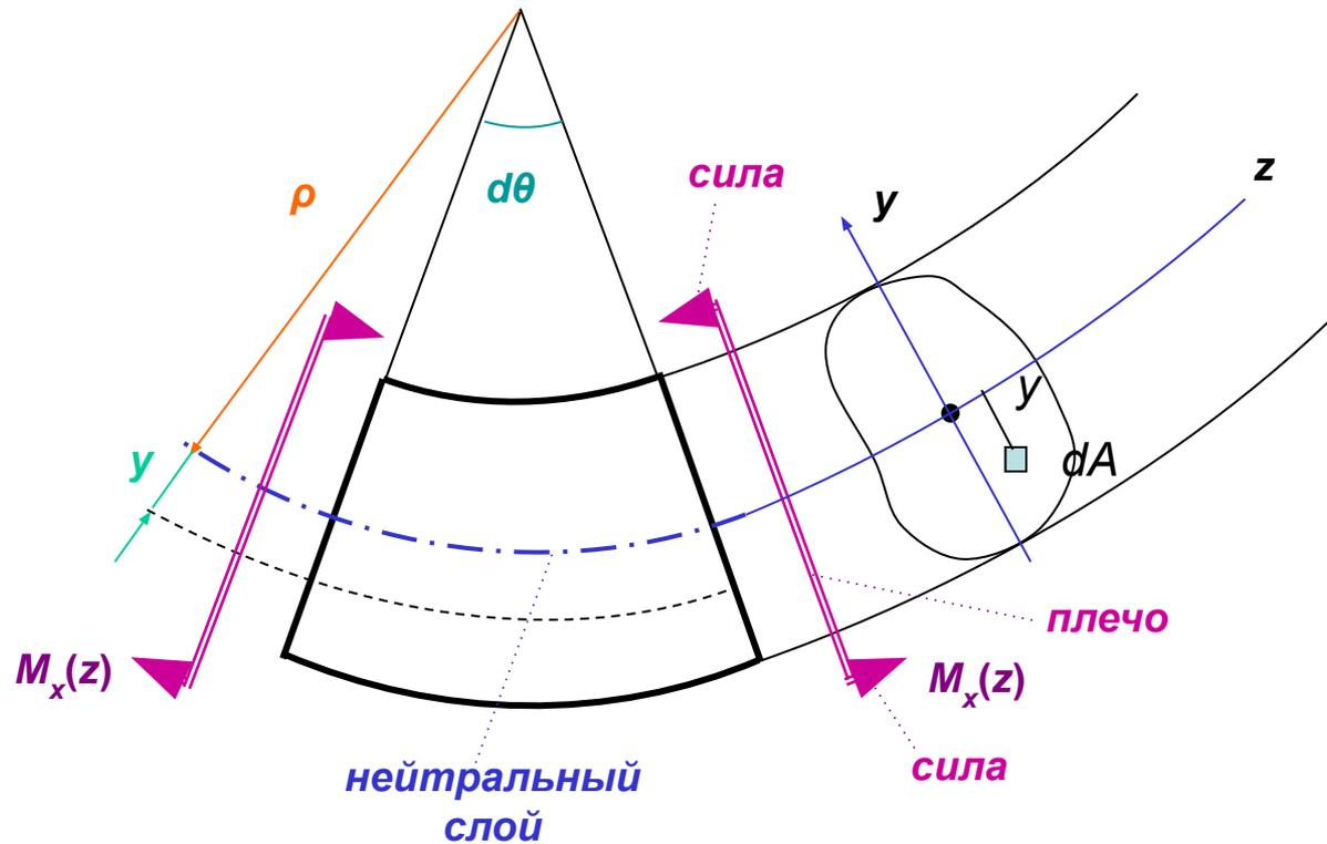
$d\theta$  — угол, общей кривизны балки
