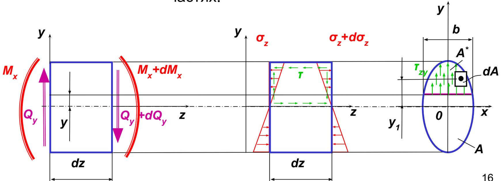
Продольным горизонтальным сечением на расстоянии  $y$  от нейтрального слоя разделим выделенный элемент на две части.
