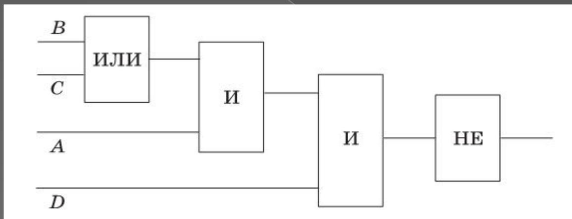
Теперь с помощью схемы рассчитаем значение формулы при  $A=C=D=1$ ,  $B=0$
