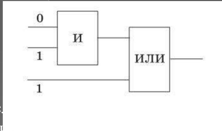
Теперь в порядке следования операция ИЛИ, по соединяющим линиям
