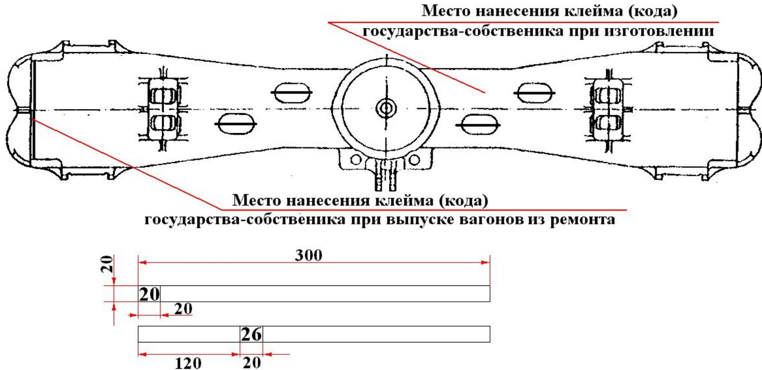
Рисунок Б.2. Мест установки клейма на надрессорной балке
