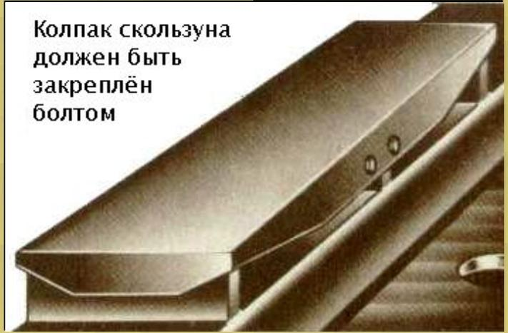
суммарный минимальный зазор между скользунами с обеих сторон тележки у всех типов четырехосных вагонов, включая хоппер-дозаторы типа ЦНИИ-ДВЗ, более 20 и менее 4 мм, кроме хопперов для перевозки угля, горячего агломерата, апатитов и хоппер-дозаторов ЦНИИ-2, ЦНИИ-3, думпкаров ВС-50, у которых зазор должен быть не более 12 и не менее 6 мм, и у думпкаров ВС-80, ВС-82, ВС-85 – не более 20 и не менее 12 мм. Допускается отсутствие зазоров между скользунами одной стороны тележки.
