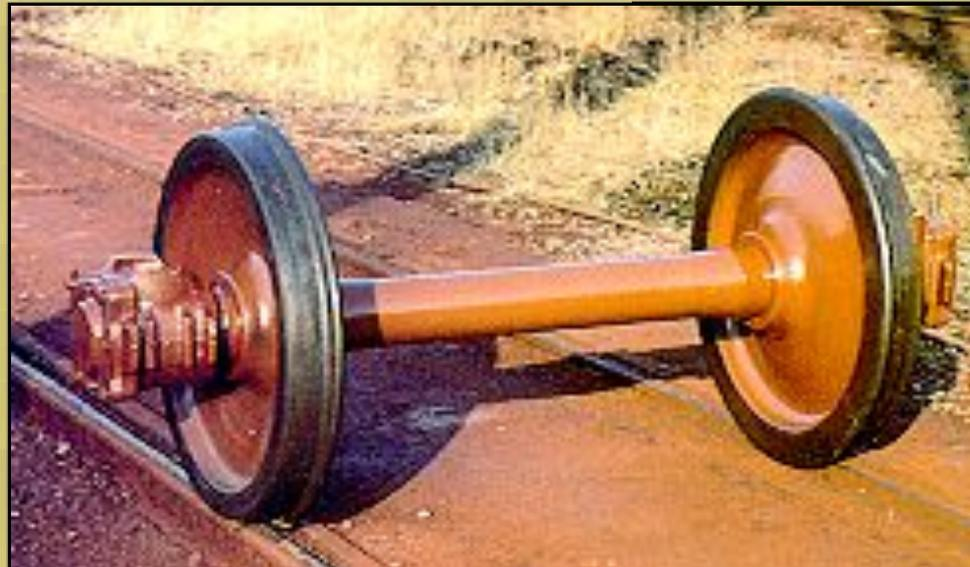
Подкатываемые под раму тележки колесные пары с буксами должны соответствовать требованиям “Инструкции по осмотру, ремонту освидетельствованию и формированию колесных пар” ЦВ / 3429 и “Инструктивными указаниями по эксплуатации и ремонту вагонных букс с роликовыми подшипниками” З-ЦВРК.
