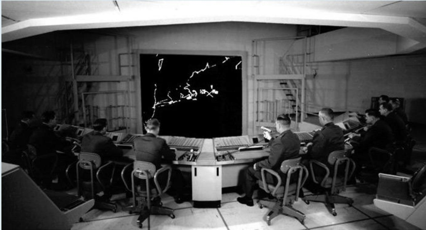
Проект *"Вихрь"* Массачусетского технологического института был отмечен как начало эры компьютерной графики. *"Вихрь"* стал основой создания опытного образца командно-управляемой системы воздушной защиты, разработанной как средство преобразования данных, полученных от радара, в наглядную форму.
