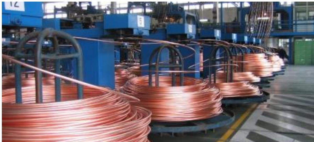
Проволоку свыше 5мм. толщиной получают прокаткой в горячем состоянии на прокатных станах . Отсюда происходит её название «катанка» .
