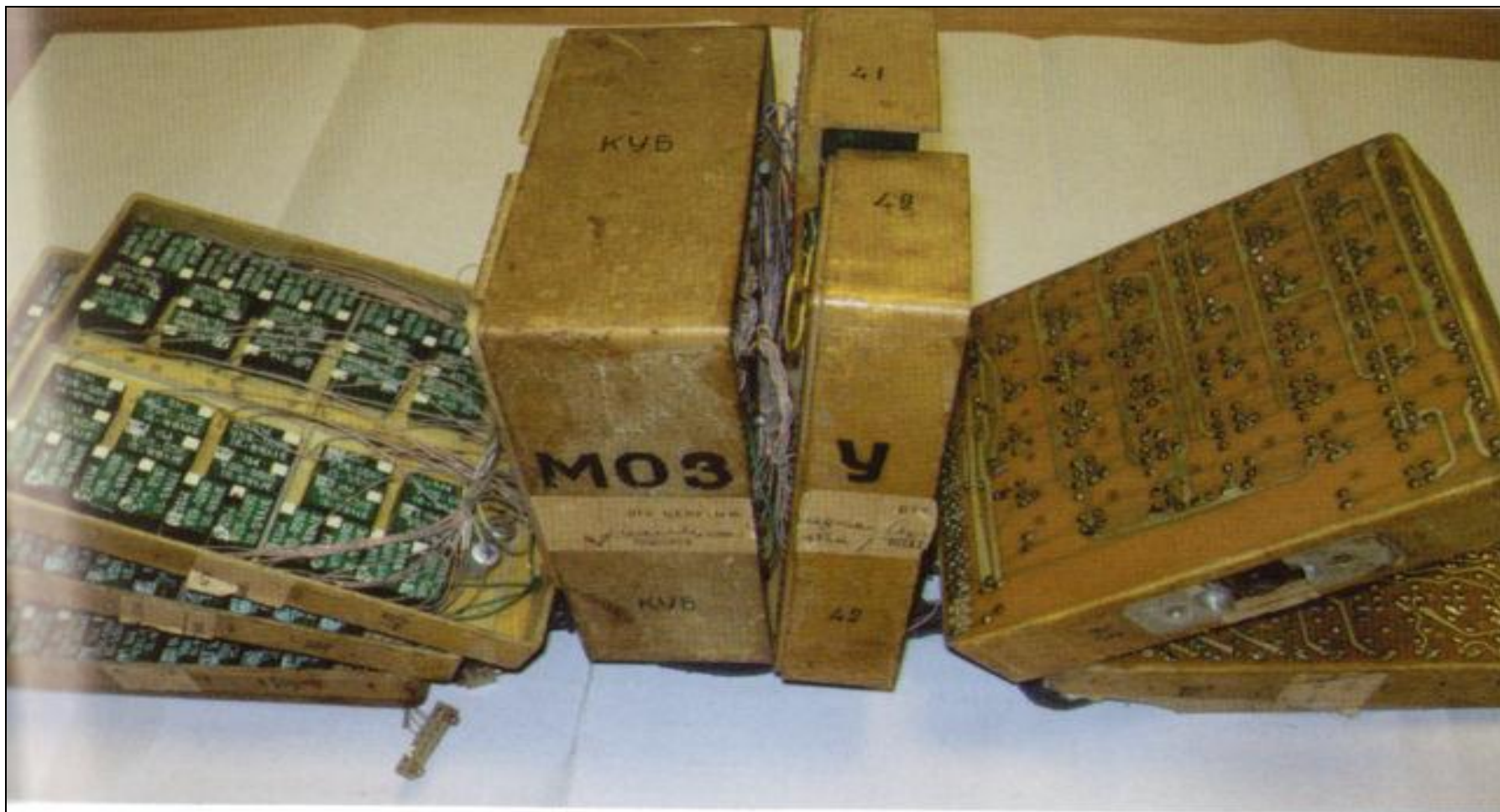
Оперативная память БЦВМ «Вычислитель». Технологический образец Уфимского завода
