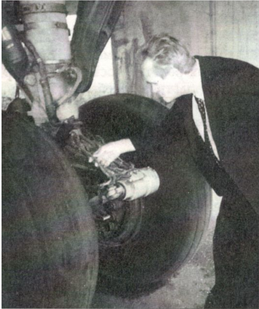
Фторопластовые рукава в системах шасси МКК «Буран»
