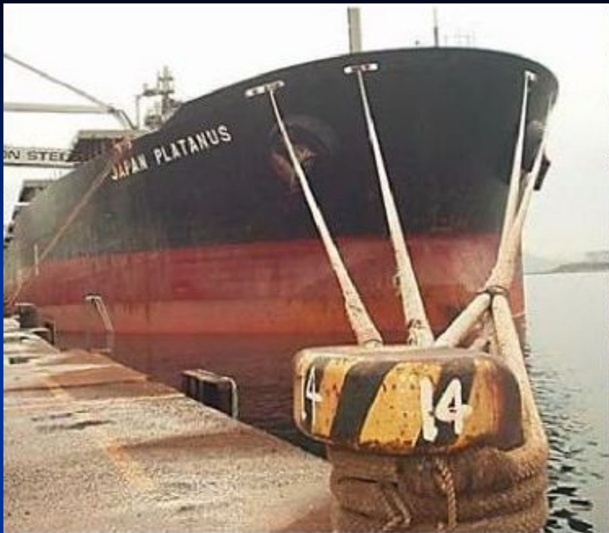
Рис. 6.35. Крепление швартовых на береговой тумбе
