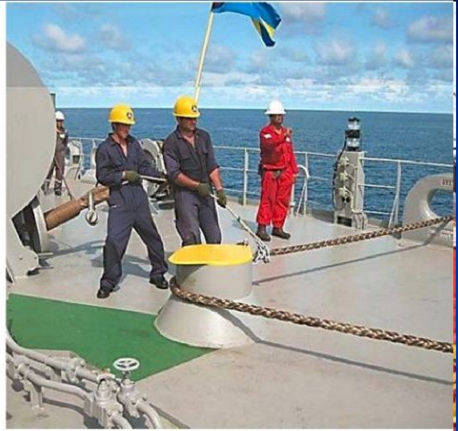
Рис. 6.46. Удержание швартовного троса стопором
