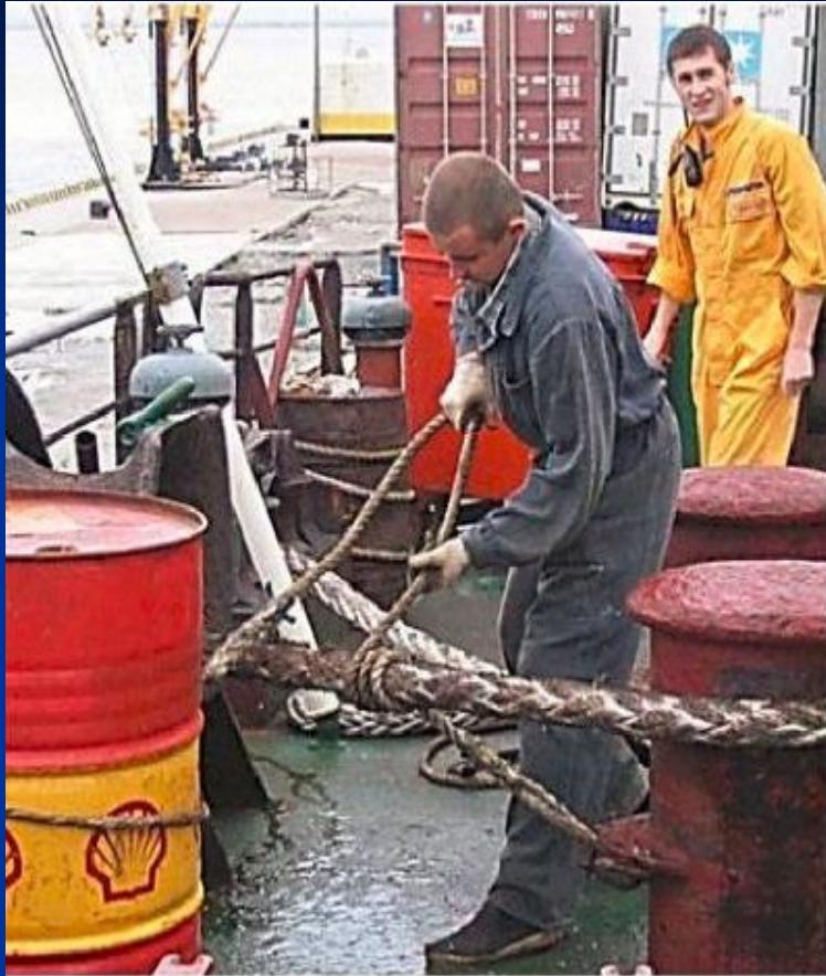
Рис. 6.46. Удержание швартовного троса стопором
