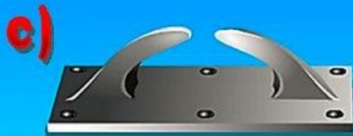
Рис. 6.40. Киповые планки: а) – с тремя роульсами; б) – с двумя роульсами; в) – без роульсов
