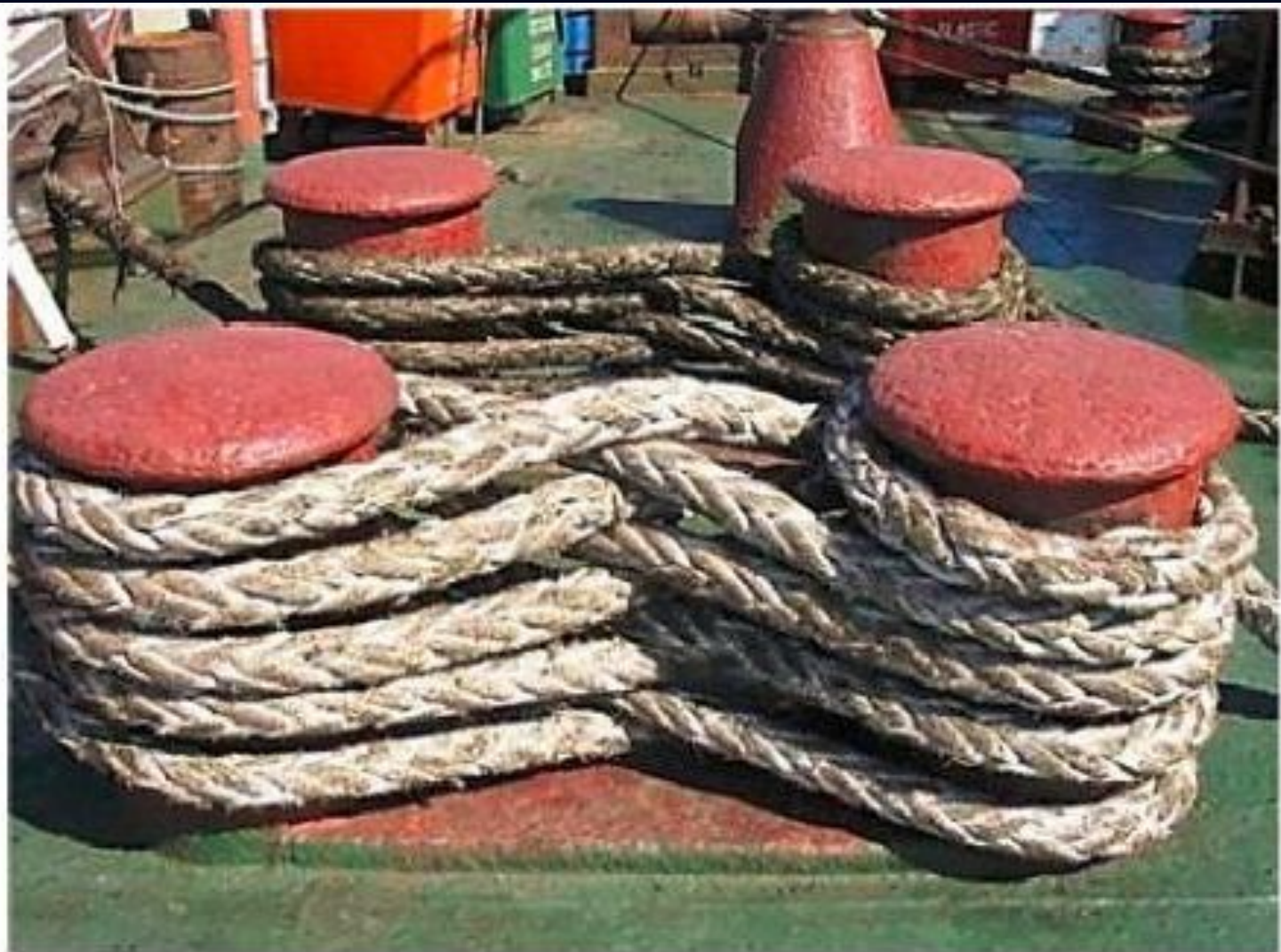
Рис. 6.37. Крепление швартовного троса на кнехте
