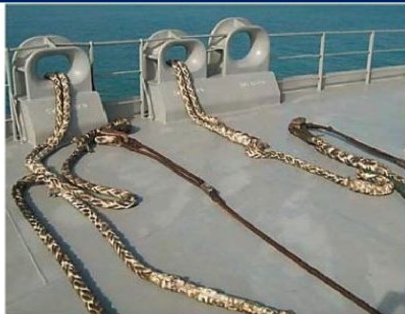
Рис. 6.45. Подготовленное для швартовки рабочее место: 1 - трос; 2 - выброска; 3 - переносной цепной стопор
