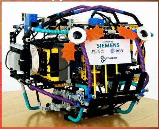
Его главной задачей стал сбор предметов, парящих в невесомости внутри МКС, таких, например, как кассеты с фотопленкой. Робот ориентируется по свету ламп на потолке МКС с помощью светового сенсора и движется на колесах, установленных на трех осях. Натолкнувшись на стену, робот продолжает движение вдоль нее.
