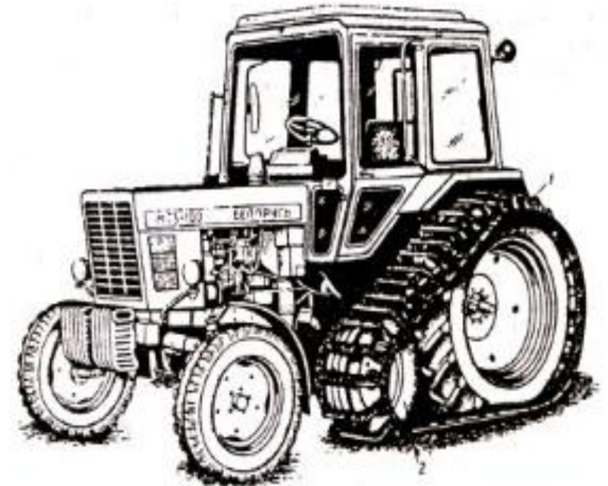
Рис. 6.41. Полугусеничный ход: 1 – гусеница; 2 – дополнительное (натяжное) колесо
