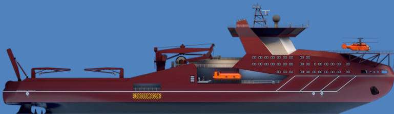
многофункциональный атомный ледокол-снабженец с функциями буксировки и якорезаводки (Icebreaker - AHTS)
