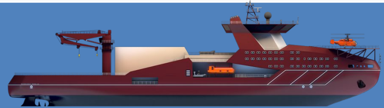
многофункциональный атомный ледокол для инспекций, технического обслуживания и ремонта подводных нефтегазодобывающих сооружений (Icebreaker - IMR)
