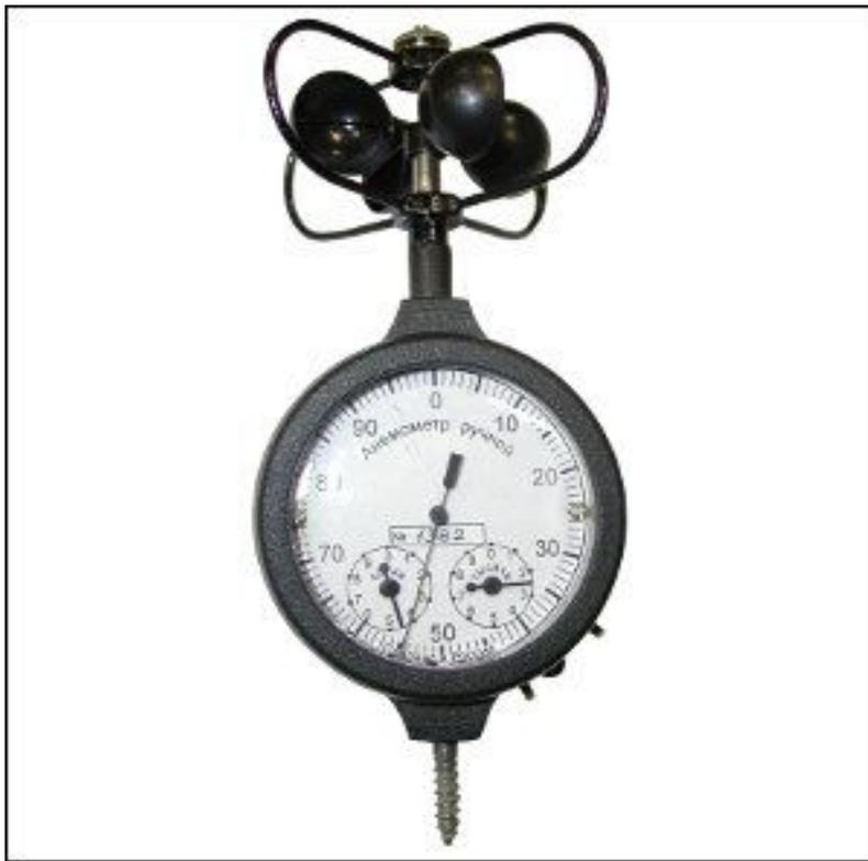
Рис. 4 - Анемометр механический чашечный МС-13
