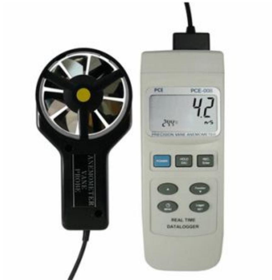
Рис. 6 - Компактный термоанемометр для измерений скорости воздуха, расход потока воздуха и температуры
