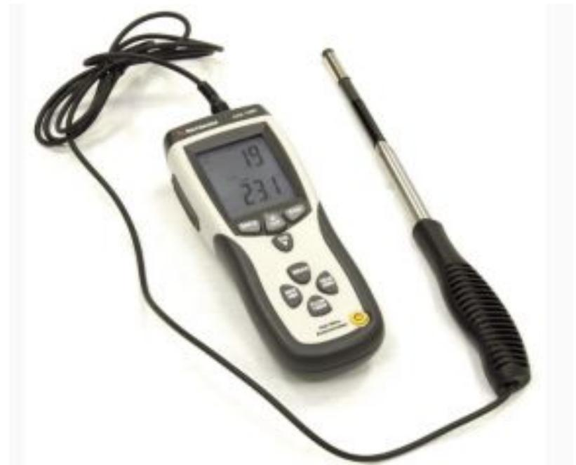
Рис. 5 - Анемометр с выносным датчиком для измерения скорости потока воздуха
