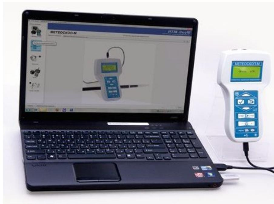
Рис. 3 - Измеритель параметров микроклимата
