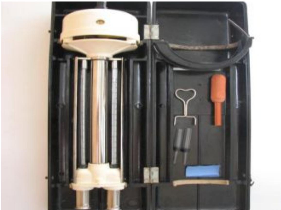
Рис. 1 - Простейший аспирационный психрометр - прибор для определения влажности воздуха
