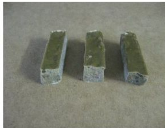
Разрушение при испытание на изгиб
