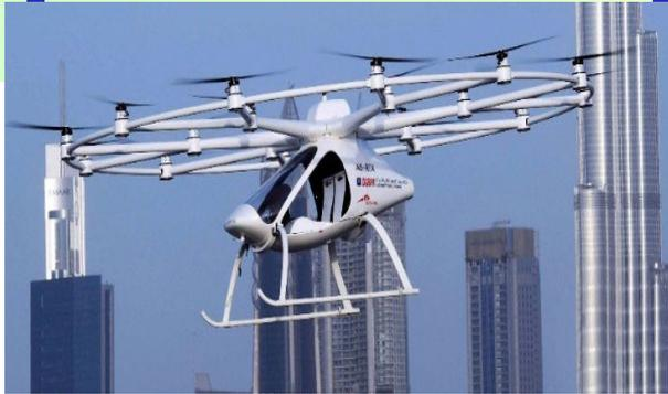
Электрический беспилотник, созданный совместно с германским производителем Volocopter, может перевозить до двух пассажиров. Время перелета мультикоптера ограничено 30 минутами: аккумулятор дрона требует подзарядки каждые 40 минут. Пока что на полную зарядку аккумуляторов требуется 2 часа, это время планируют значительно сократить до начала серийного выпуска аппарата. Максимальная скорость беспилотного такси составляет
