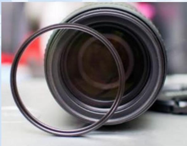
В устройство объектива также входит резьба для фильтра, которая расположена вокруг внешней линзы. На эту резьбу можно прикручивать различные фильтры и другие аксессуары для объективов. На каждом объективе есть пометка о диаметре этой резьбы, чтобы фотограф мог подобрать фильтр по размеру.
