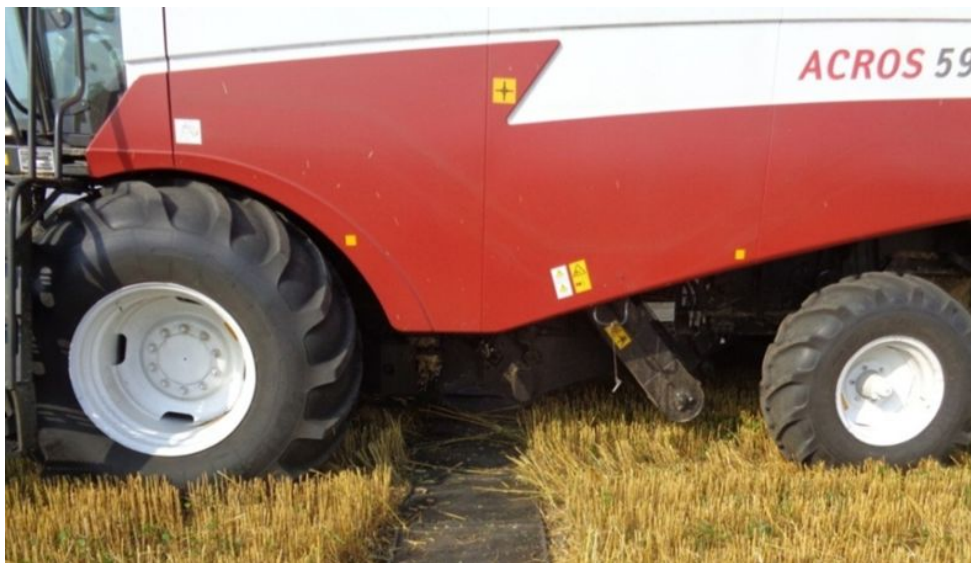
Рисунок – Проход зерноуборочного комбайна РСМ-152 «ACROS-595 Plus» при определении суммарных потерь зерна
