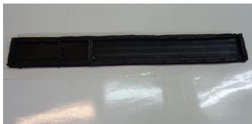
Резиновый коврик формы № 2 с размерами 750x100x20 мм
