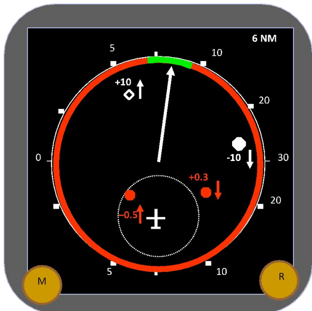
Информация БСПС на индикаторе вертикальной скорости (VSI)
