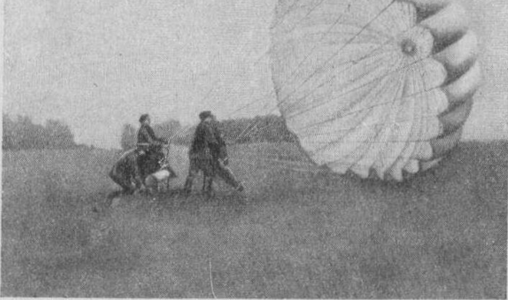
Рис. 8. Приземление куклы-манекена с испытываемым парашютом.
