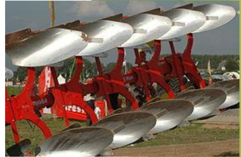
Плуг - оборудование для вспашки земли
