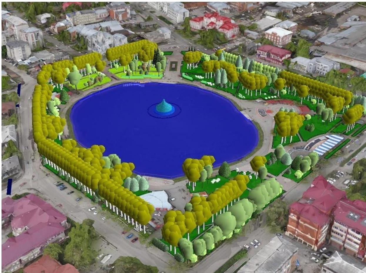
Здесь приведен слайд с уже функционирующего портала «Томск 3D», на котором создана фотореалистичная 3D-модель, ортофотоплан с пространственным разрешением 5 см на пиксель и точностью в плане 15 см.
