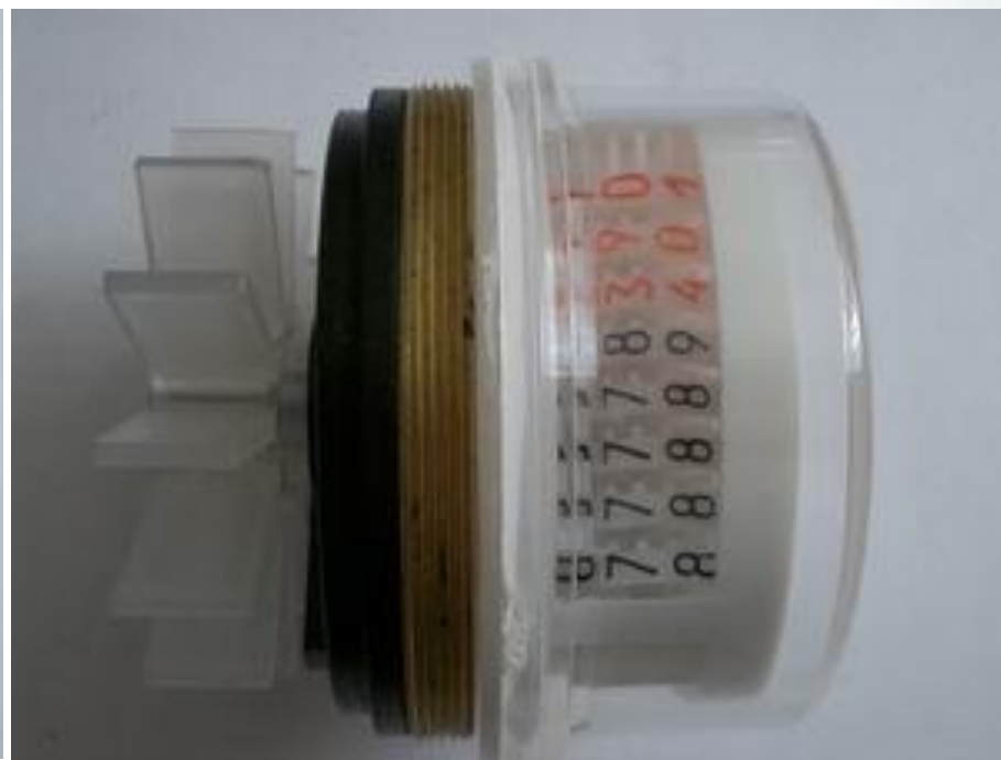
Обычный механизм счетчика, кольцо не предусмотрено.
