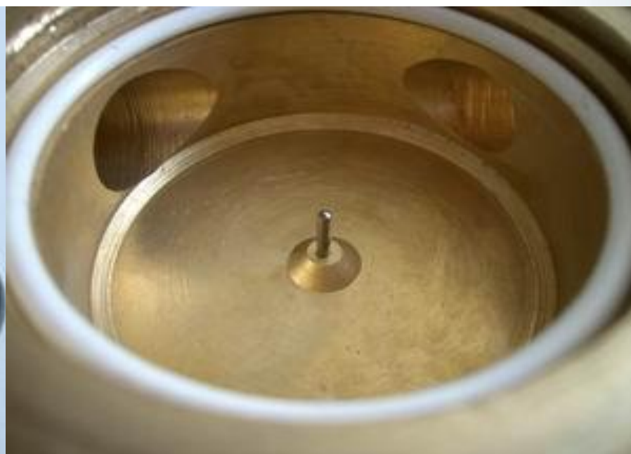
Полуось крыльчатки счетчика производства ООО Бетар-Восток. Толщина оси заметно меньше. Материал уплотнительного кольца низкого качества.
