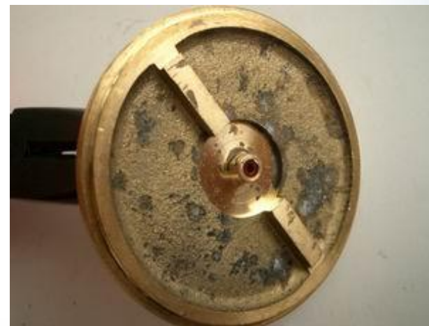
Крышка отечественного счетчика, имеет 2 калибровочных выступа.
