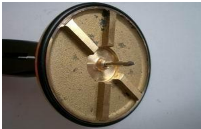
Крышка проточной части счетчика Unimag. Крышка имеет 4 калибровочных выступа.
