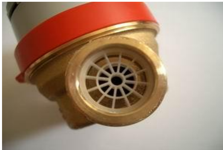
Фильтр счетчика Unimag, имеет оригинальную конструкцию
