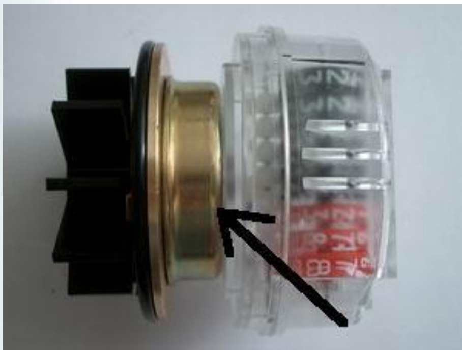
Механизм счетчика Unimag, стрелкой отмечено противообманное кольцо, защищающее магнитную передачу,
