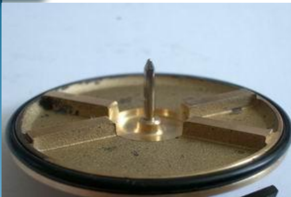
Крышка проточной части счетчика Unimag, в центре закреплена полированная ось крыльчатки. Уплотнение крышки выполнено из резины высокого качества
