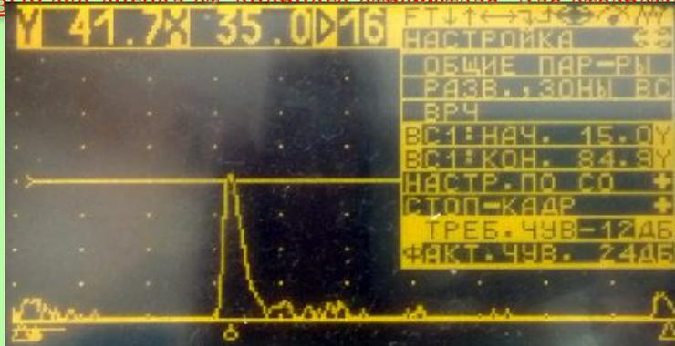
Эхо-сигнал от отверстия  $\varnothing 6$  мм на глубине 44 мм
