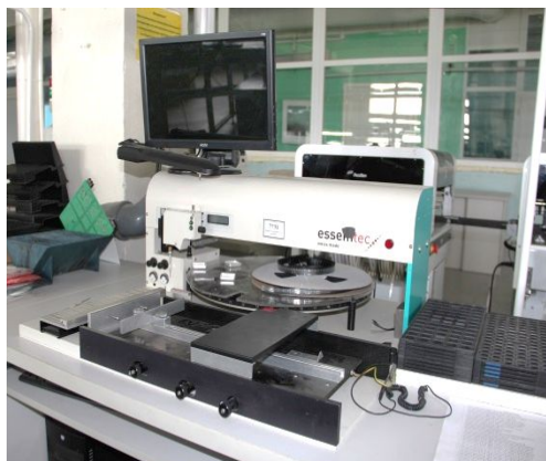
Полуавтомат установки SMD-элементов EXPERT-SAFP
