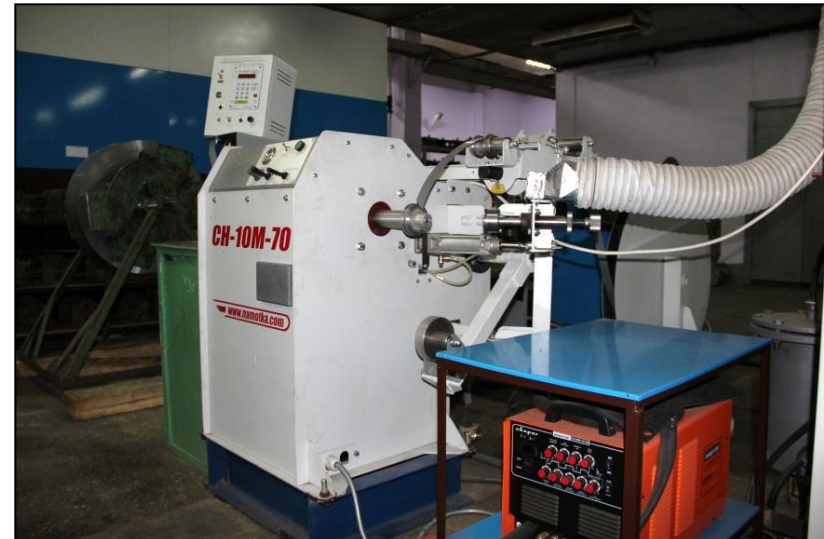
Станок для намотки витых магнитопроводов CH-10M-10.1
