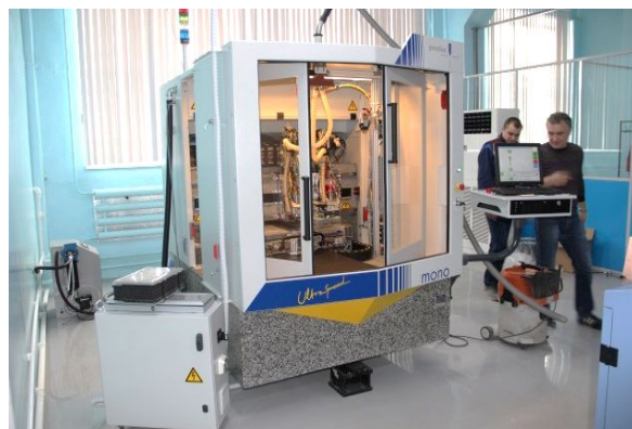
Высокоточный двухшпиндельный сверильно-фрезерный станок Ultraspeed Mono Combi
