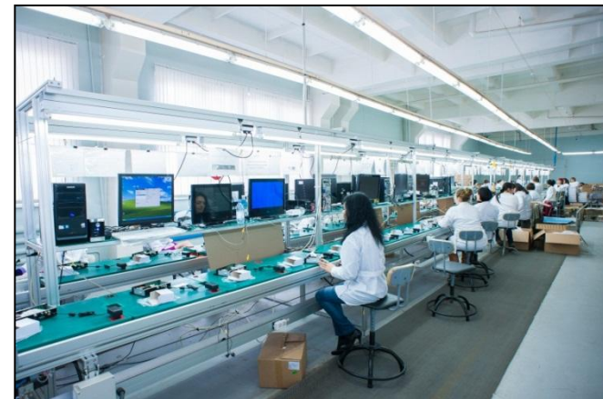
Конвейерная линия сборки на 27 рабочих мест
