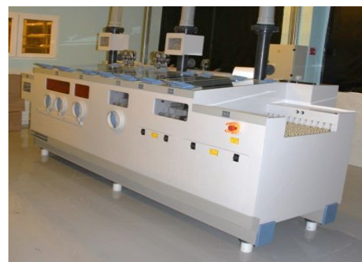
Конвейерная компактная двухкамерная линия проявления паяльной маски с модулем тепловой сушки LD-400 2DSM
