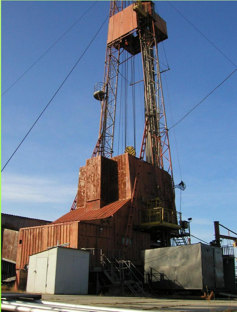
**Буровая установка** - это комплекс наземного оборудования, необходимый для выполнения операций по проводке скважины. В состав буровой установки входят •-
