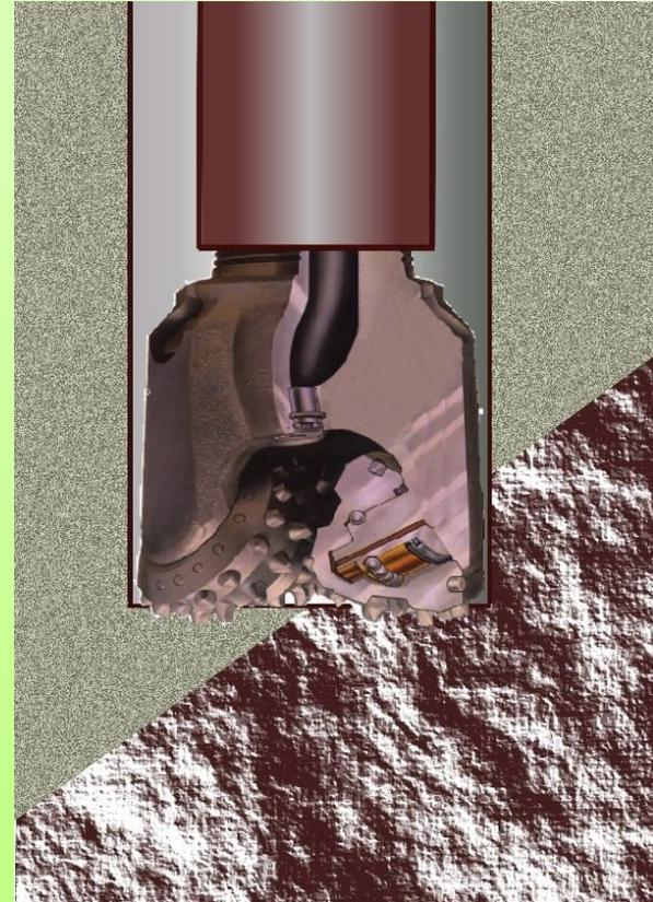
**По характеру разрушения горных пород на забое** различают сплошное и колонковое бурение. При сплошном бурении разрушение пород производится по всей площади забоя. **Колонковое** бурение предусматривает разрушение пород только по кольцу с целью извлечения **керн** - цилиндрического образца горных пород на всей или на части длины скважины. С помощью отбора кернов изучают свойства, состав и строение горных пород, а также состав и свойства насыщающего породу флюида.
