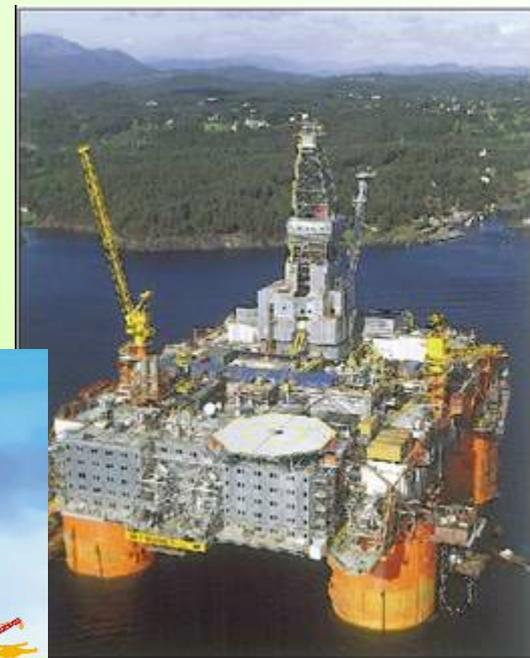
**Нефтяные и газовые скважины бурят на суше и на море при помощи буровых установок. В последнем случае буровые установки монтируются на эстакадах, плавучих буровых платформах или судах.**
