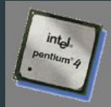
Реализуется процессор в виде большой интегральной схемы (БИС) на которой размещаются десятки миллионов функциональных элементов.
