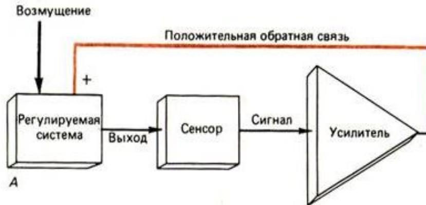
*Действующее на систему возмущение усиливается, и усиленный сигнал поступает на вход системы без изменения его знака*
