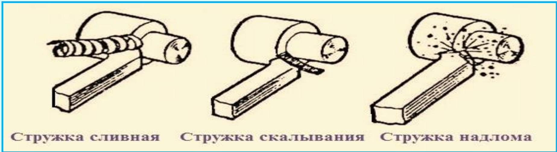
**Сливная стружка** похожа на ленту, закрученная в спираль. Гладкая и блестящая сливная стружка образуется при точении вязких и мягких металлов.
