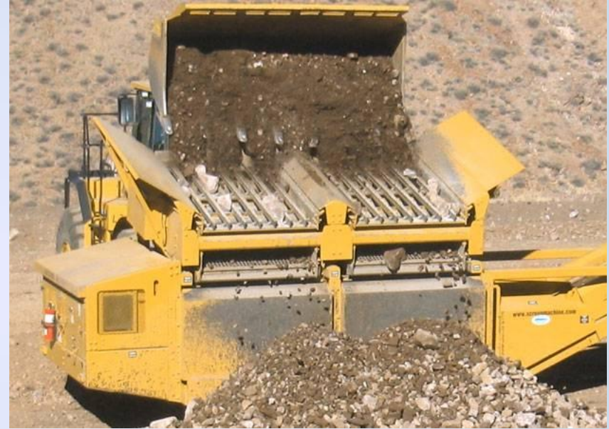
Рис. 5 Колосниковый грохот в работе [3]
