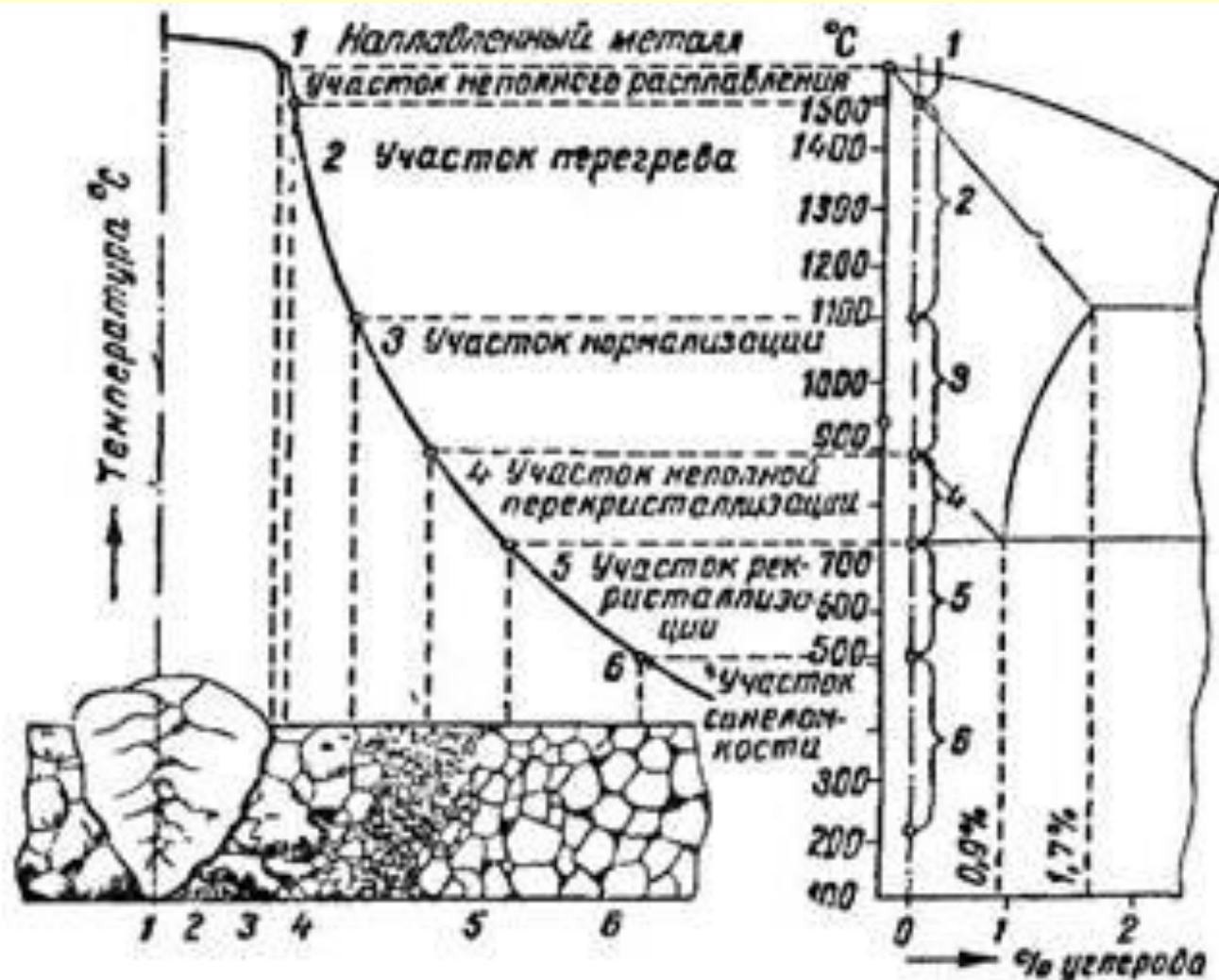
Рис. 27. Схема строения зоны влияния при ручной дуговой сварке малоуглеродистой стали. Цифрами 1, 2, 3, 4, 5 и 6 обозначены одни и те же участки на разрезе металла шва, кривой и шкале температуры на диаграмме
