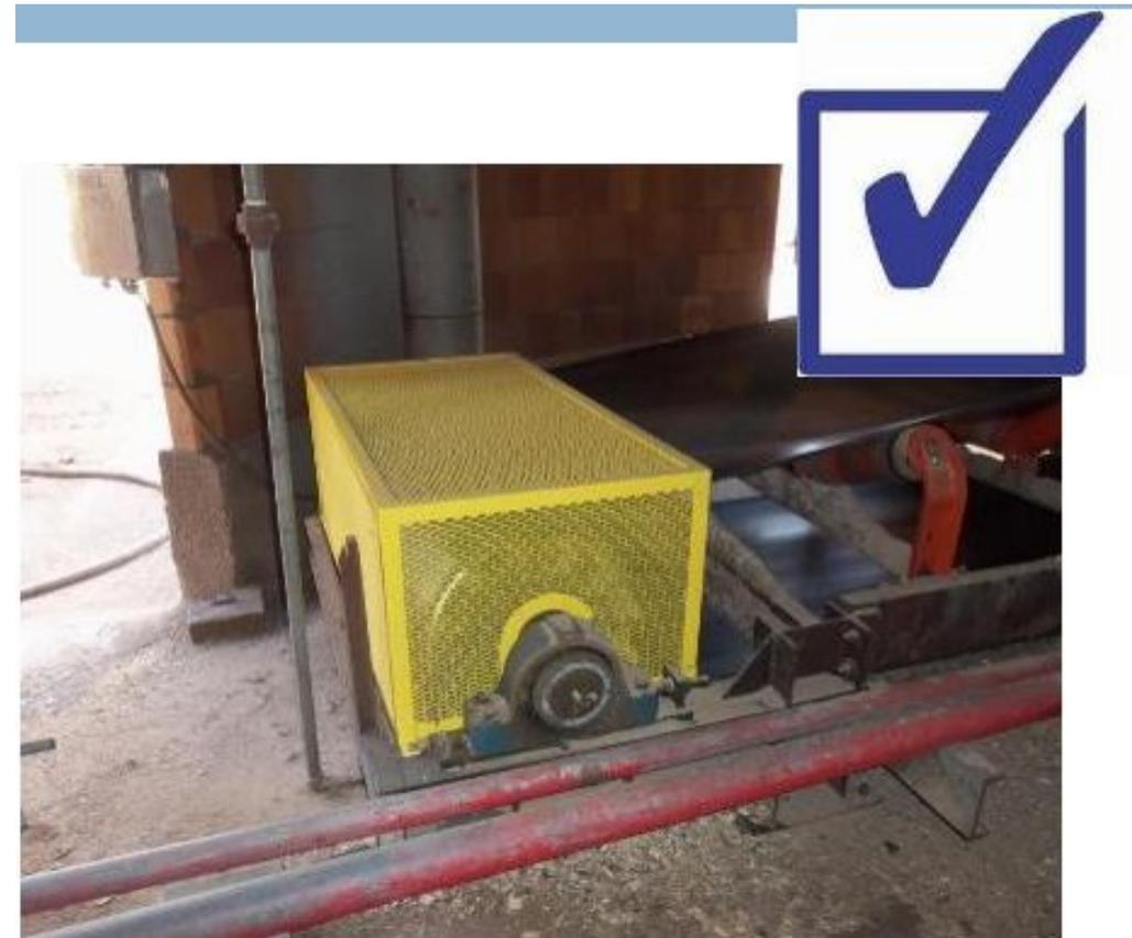
Ограждения **ДОЛЖНЫ БЫТЬ** установлены для **предотвращения** касания вращающегося оборудования пальцами и руками.
