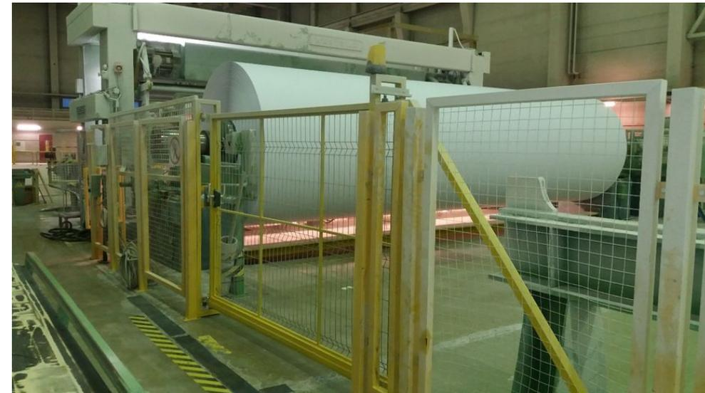
Ограждения также могут выполняться в виде защитного периметра, напр., защитных перил или ограды. "Защита при помощи дистанции" обеспечивает безопасное расстояние от опасности.
