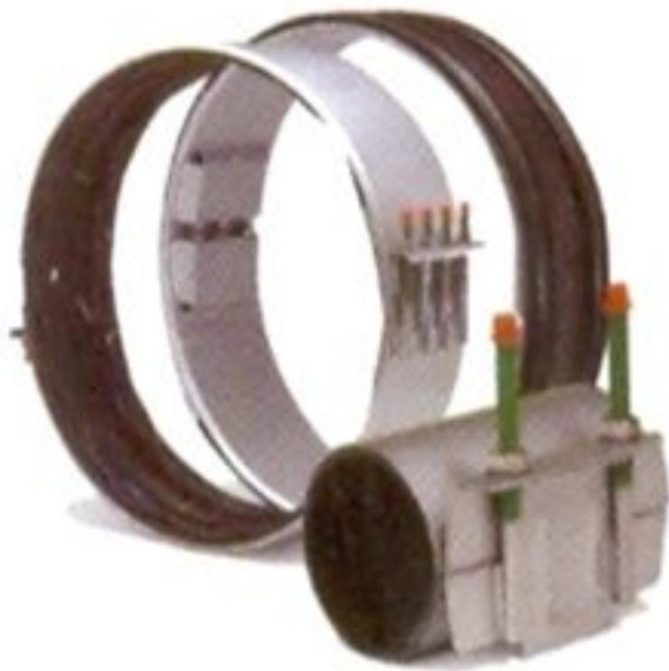
**Ленточный ремонтный хомут предназначен для ремонта трубопроводов из стали, чугуна, ПВХ или асбестоцемента. Изготовлен из нержавеющей стали, внутри резиновое уплотнение с ячеистой структурой. Существуют модификации как для наружного ремонта, так и для внутреннего. Диаметр обжимаемой трубы DN 40-1200 и выше. Длина хомутов от 100 мм до 1000 мм.**
