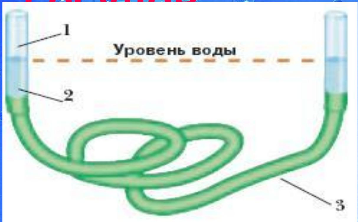
\* В сообщающихся сосудах любой формы и сечения поверхности однородной жидкости устанавливаются на одном уровне( если давления воздуха над жидкостью одинаково ).
