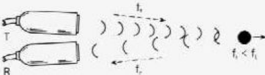
Допплеровский сдвиг частоты  $f_{\sigma} = f_r - f_t$
